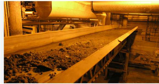
Рис. 2. Інерційні конвеєри для транспортування золи
