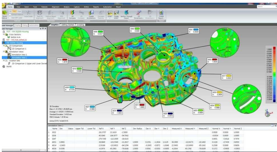
Рис. 4. Проведення поверхневої дефектоскопії та контролю лінійних розмірів деталей
