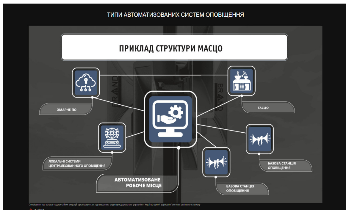
Рис.2.4. Приклад структури Місцевої автоматизованої системи централізованого оповіщення
