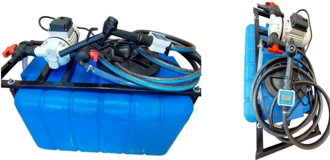
Рисунок 2.3.6. Заправна станція (змішувач для робочого розчину)
