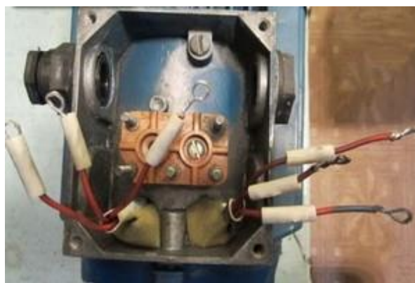
Рисунок 2.2 – Шість виводів обмотки статора асинхронного двигуна
