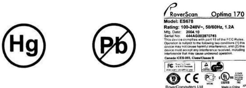
Рисунок 14 – Знаки «Продукція містить ртуть», «Відсутність свинцю», приклад маркування монітора
