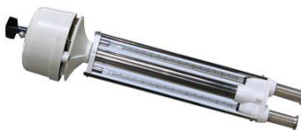
Рис. 3. Аспіраційний психрометр Ассмана
