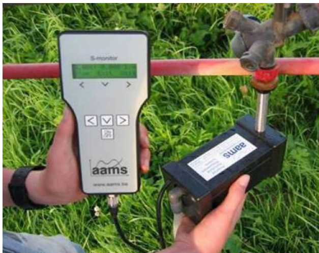
Рис.1.2. електронні витратоміри: А) з лійкою, Б) з трубчастим адаптером.
