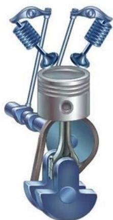
Рис. 2.2. ГРМ з верхнім розташуванням клапанів: 1 – клапан; 2 – напрямна втулка; 3 – пружина; 4 – штовхач; 5 – кулачок розподільного валу; 6 – регулювальний гвинт; 7 – натискний важіль (коромисло); 8 – штанга; 9 – шестерня розподільного валу; 10 – шестерня колінчастого валу
