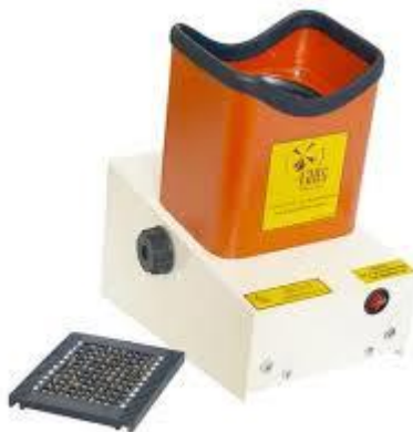
Рис. 1.2 – Діафаноскоп для визначення скловидності зерна ДСЗ – 3
