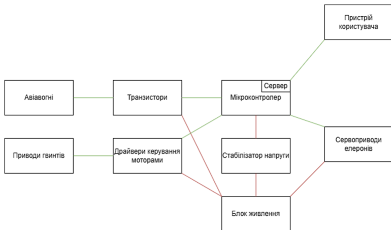
Рис. 2. Структура схема системи дистанційного керування
