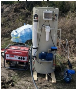
Рисунок. Водоочисна блочно-модульна установка комплексного глибокого очищення води
