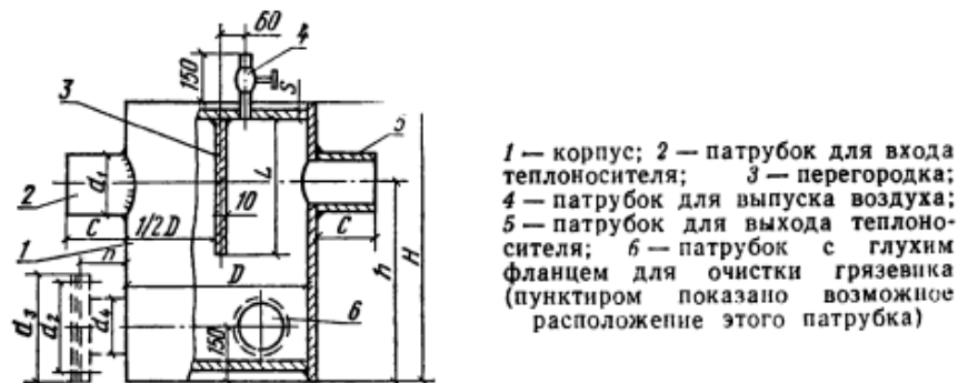
Рис.3.5 Схема грязевика ОРГРЕС
