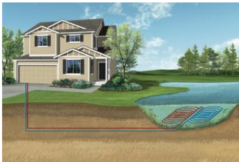
Рис. 1.9 Геотермальний тепловий насос з притопленим контуром (система “вода-вода”)
