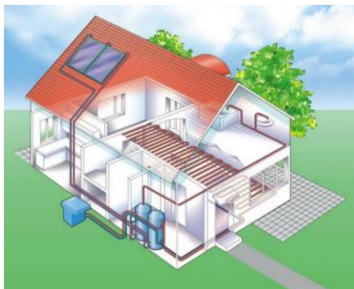
Рис. 1.11 Повітряний тепловий насос (система “повітря-вода”)
