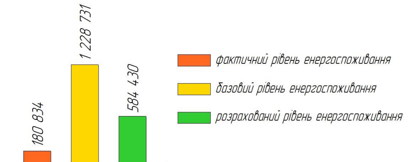
Рис. 4.4. Порівняння фактичного, базового та розрахованого рівня енергоспоживання гуртожитку №4 НУВГП, кВт·год/рік.
