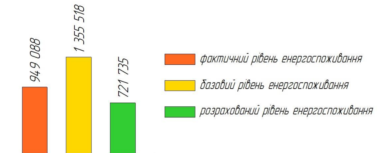
Рис. 4.2. Порівняння фактичного, базового та розрахованого рівня енергоспоживання гуртожитку №2 НУВГП, кВт·год/рік.
