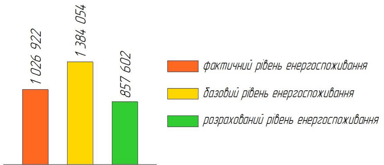
Рис. 4.1. Порівняння фактичного, базового та розрахованого рівня енергоспоживання гуртожитку №1 НУВГП, кВт·год/рік.
