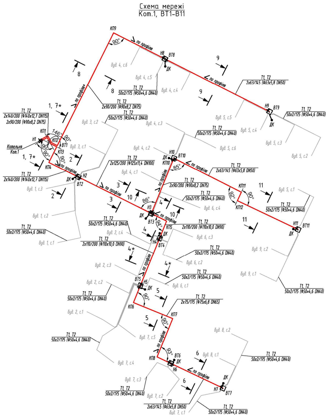
Рис. 3.1. Схема тепломережі житлового масиву
