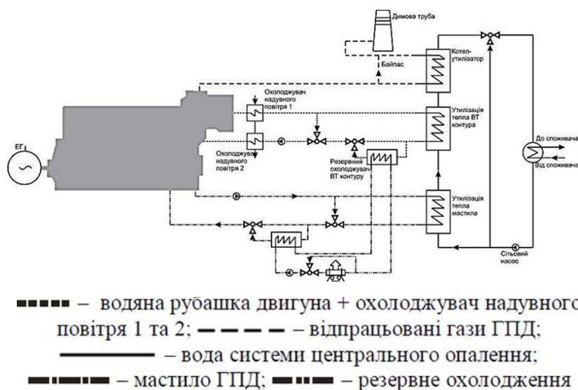
Рисунок 2.16 – Принципова теплова схема ГПД ТЕЦ
