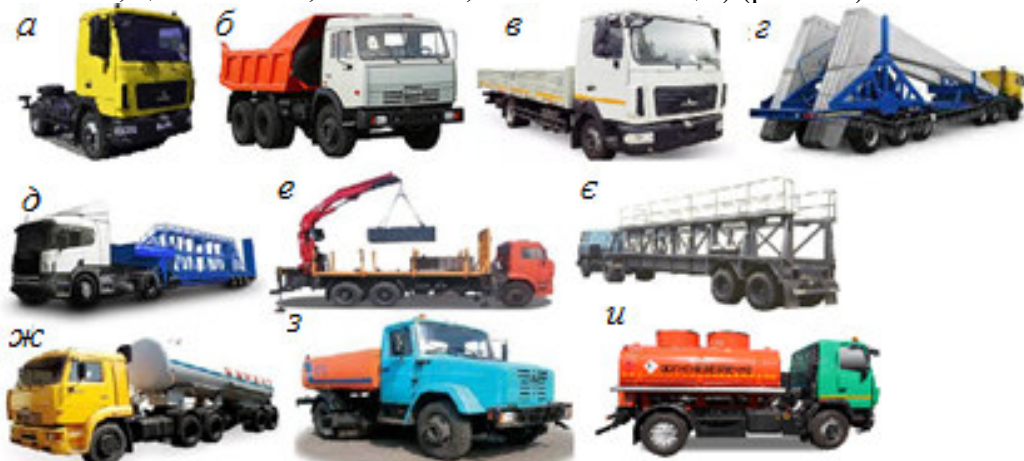
Рис. 3.1. Автотранспортні засоби для перевезення будівельних вантажів: а – тягач; б – автосамоскид напівпричіп для перевезення плит; в – бортовий автомобіль; г – колоновоз; д – панелевоз; е – спеціалізований напівпричіп з маніпулятором; є – фермовоз; ж – цементовоз; з – водовоз; и – паливозаправник, https://specmash.org.ua/article/tipi-i-vidi-vantazhnih-avtomobiliv ; https://zakupka.com/uk/odessa/t/avtocisterny-285/ , https://varz.ua/ru/napivprichip-paneleviz-varz-npp-3811
