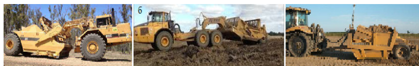
Рис. 2.21. Загальний вигляд скреперів: а – самохідного; б – напівпричіпного; в – причіпного, https://presa.com.ua
