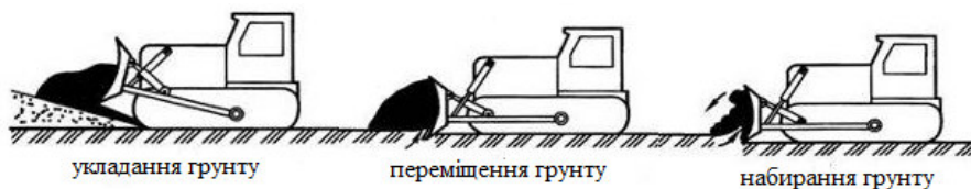
Рис. 2.17. Схема циклу роботи бульдозера
