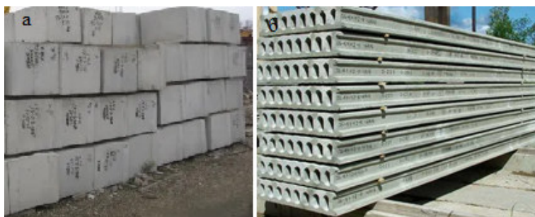
Рис. 3.8. Штабелі фундаментних блоків( а ), плит перекриття ( б ),
