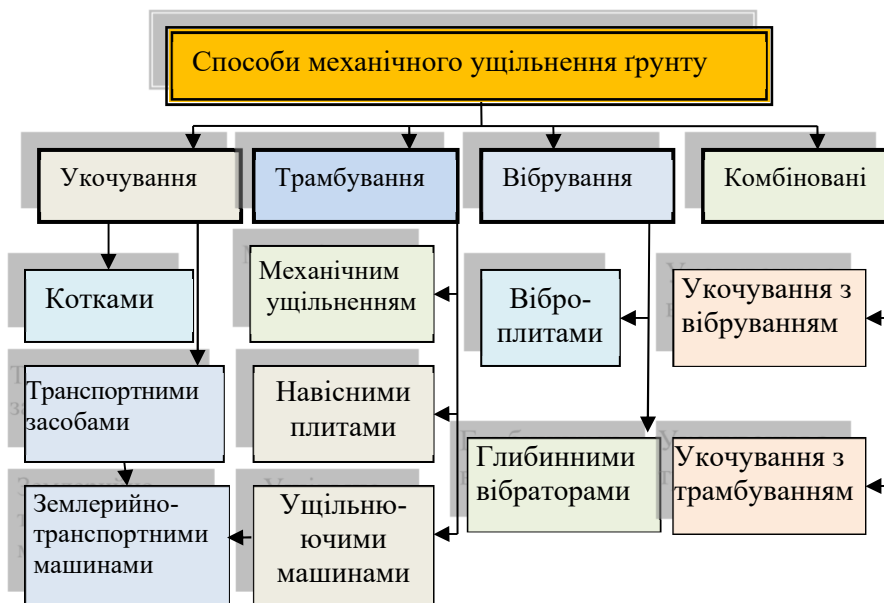
Рис. 2.48. Способи механічного ущільнення ґрунту
