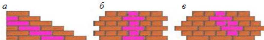
Рис. 5.9. Види перев'язки вертикальних швів цегляної кладки: а – \frac{1}{2} цеглини; б, в – \frac{1}{4} цеглини
