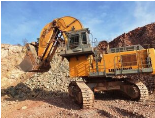
Рис. 2.28. Екскаватор з робочим обладнанням пряма лопата, https://machineryline.ua
