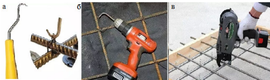
Рис. 4.15. Зв'язування арматурних стрижнів: а – в'язальним гачком; б – шурупвертом; г – пістолетом, https://isu.org.ua/yak-v-yazaty-armaturu-dlya-pochatktivsiv-sposoby-normy-i-pravyla-karkas-pid-fundament/
