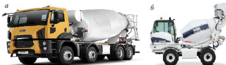
Рис. 4.23. Автобетонозмішувачі: а – на базі автомобіля; б – на базі самохідного шасі, https://kievspecteh.com/catalog/avtobetonozmishuvach ; https://aleanda.com/product_cat/fiori-avtobetonozmishuvachi/
