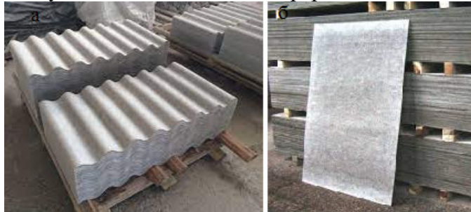
Рис. 3.16. Складування шиферу: а – хвильового; б – плоского, https://odessa.kub.in.ua/ua/shkola-remonta/kak-pravilno-khranit-listy-shifera
