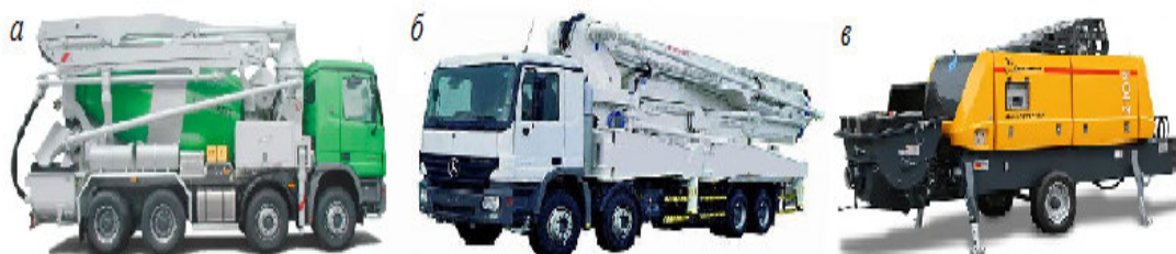
Рис. 4.28. Бетонопомпні установки: а – гібрид на платформі автобетонозмішувача; б – на шасі автомобіля; в – причіпна, https://stroytexnika.com.ua/betononasos ; https://hydrolider.com.ua/ua/p1286365067-betononasos-putzmeister-bsa.html
