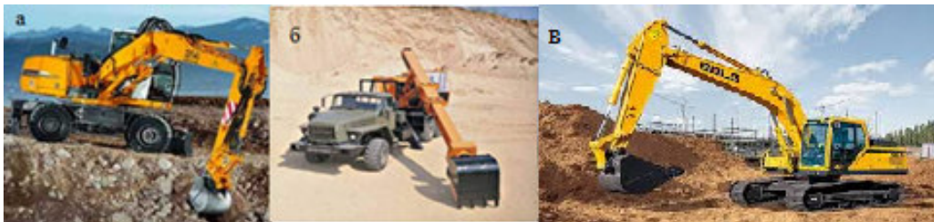
Рис. 2.29. Екскаватори з робочим обладнанням зворотна лопата: а – на пневмоколісному ходу; б – на автомобільному шасі; в – на гусеничному ходу, https://hydromarket.com.ua/ua
