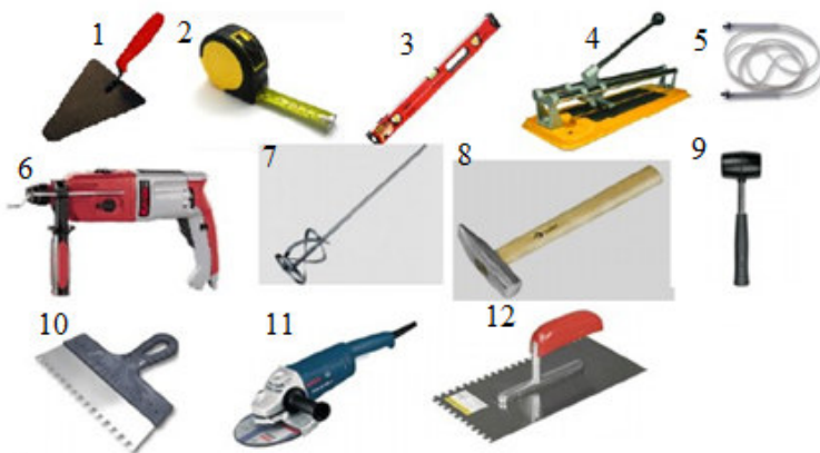
Рис. 7.13. Інструмент для виконання облицювальних робіт: 1 – кельма; 2 – рулетка; 3 – будівельний рівень; 4 – плиткоріз; 5 – водяний рівень; 6 – дріль; 7 – мішалка; 8 – молоток металевий; 9 – молоток гумовий; 10 – зубчастий шпатель; 11 – кутова шліфувальна машинка (болгарка); 12 – зубчастий шпатель двосторонній, https://naurok.com.ua/prezentaciya-oblicyuvannya-vertikalnih-poverhon-334105.html
