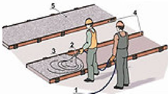
Рис. 7.36. Схема влаштування ксилолітової підлоги: 1 – шланг подачі суміші; 2 – форсунка; 3 – суміш, що вкладається; 4 – маячні рейки; 5 – вкладена суміш
