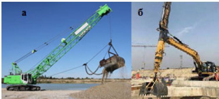
Рис. 2.30. Екскаватори з робочим обладнанням драглайн (а), грейфер (б), https://www.regdorstroy.kiev.ua/
