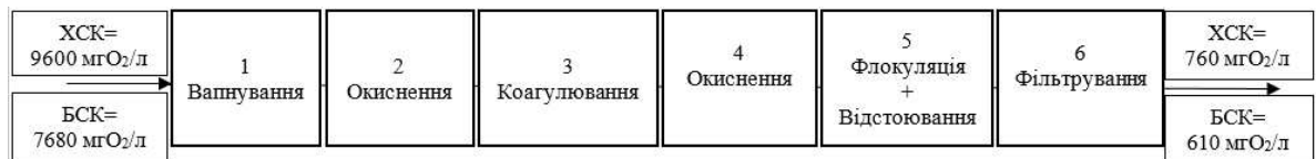
Рис. 3.22. Фізико-хімічне очищення сильноконцентрованих стічних вод (II, ХСК=9600 мгО₂/л, БСК повн =7680 мгО₂/л)
