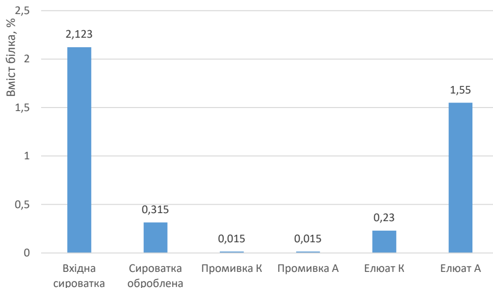
Рис. 3.16. Акумуляція вилучених білків у процесі послідовного \text{Na}^+ -катіонування та \text{OH}^- -аніонування (сильнокисло-окислювальне середовище)
