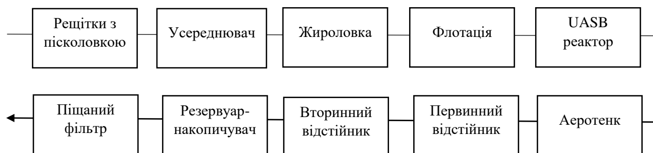
Рис. 1.18. Впроваджена схема комбінованого механічного, фізико-хімічного та анаеробно-аеробного очищення концентрованих стічних вод молокозаводу
