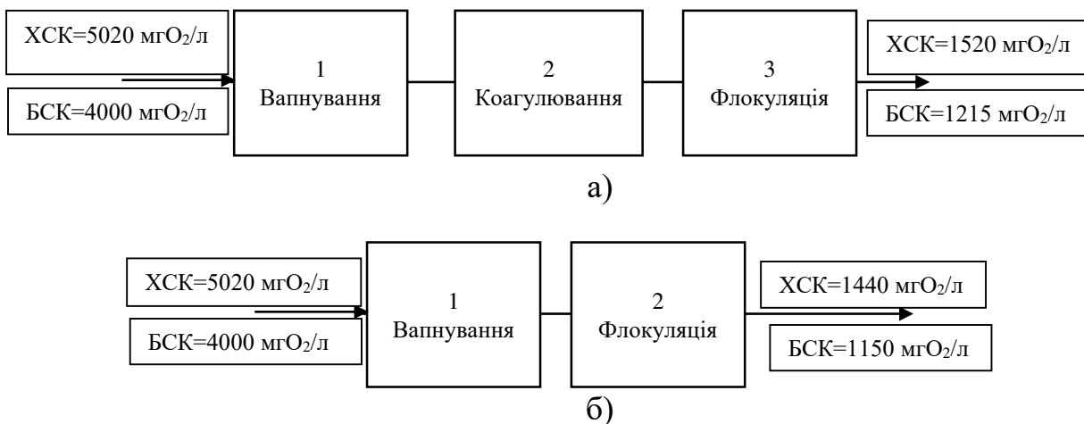
Рис. 3.21. Фізико-хімічне очищення концентрованих стічних вод (І, ХСК=5020 мгО 2 /л, БСК ПОВН =4000 мгО 2 /л)
