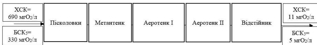
Рис. 3.31. Глибоке біологічне очищення слабкоконцентрованих стічних вод молокозаводів
