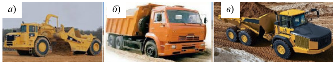
Рис. 7.7. Засоби для транспортування ґрунту: а – скрепер ( https://zeppelin.ua/products/wheel-tractor-scrapers/631g/ ); б – автосамоскид ( https://flagma.ua/uk/products/ ); в – тракторний візок
