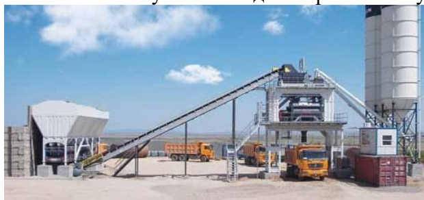
Рис. 3.28. Інвентарний швидкокорозбірний бетонний вузол, https://www.elkon.net/products/ , [1]
