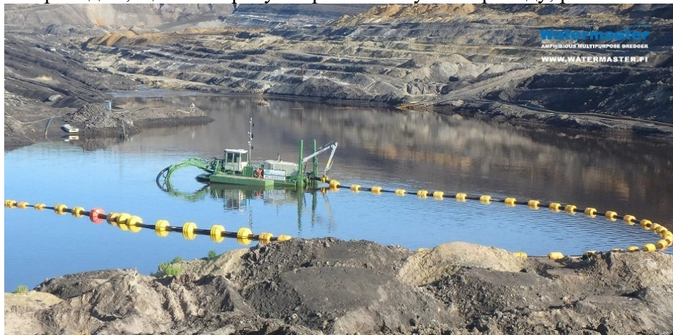
Рис. 3.21. Застосування плаваючого пульпопроводу, watermaster.fi/
