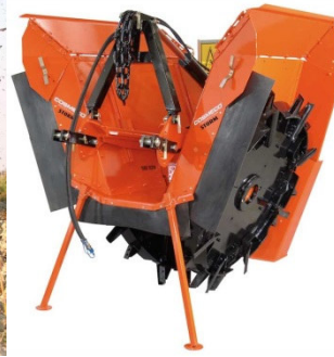
Рис. 1.16. Розробка каналів дрібної мережі ротаційним двохроторним канавокапачем Cosmeso BIG STORM (а) та його робочий орган (б). Фото з сайту https://agro-sintez.com.ua/product/kanalokopatel-dvuhrotornyi-big-storm/
