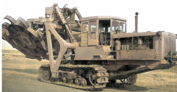
Рис. 1.13. Двохфрезерний каналокочач ЕТР-122: а – вид ззаду; б – спереду, [1]
