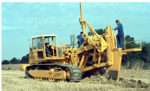
Рис. 4.14. Безтраншейний дренаукладач для труб діаметром до 150 мм, фото з сайту: https://www.landwirt.com
