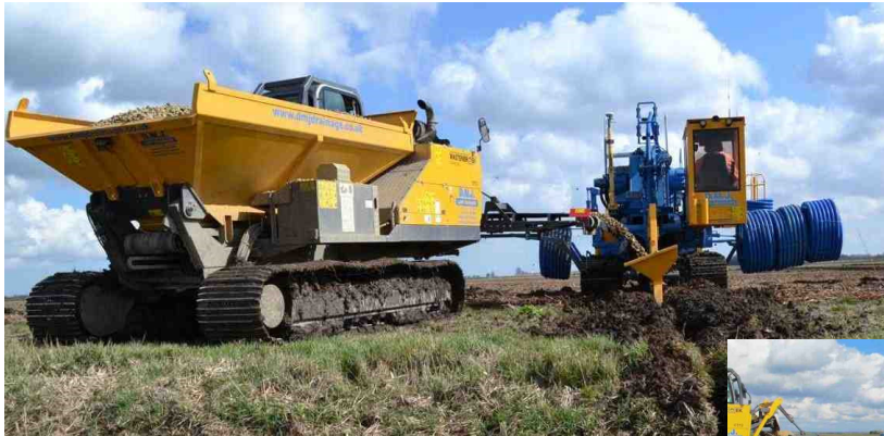
Рис. 1.45. Гусеничний візок для транспортування і навантаження в бункер дренаукладача Mastenbroek 30/20 фільтруючого матеріалу, [24]
