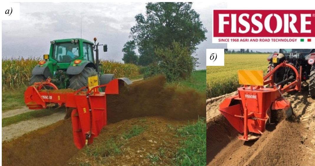
Рис. 1.19. Формування осушувальних каналів з використанням обладнання Fissore (Італія): а – зі зміщенням відносно вісі руху машини до 4 м, MPL.590; б – по вісі руху, MP.571, [18]. Джерело фото: https://fissore.it/
