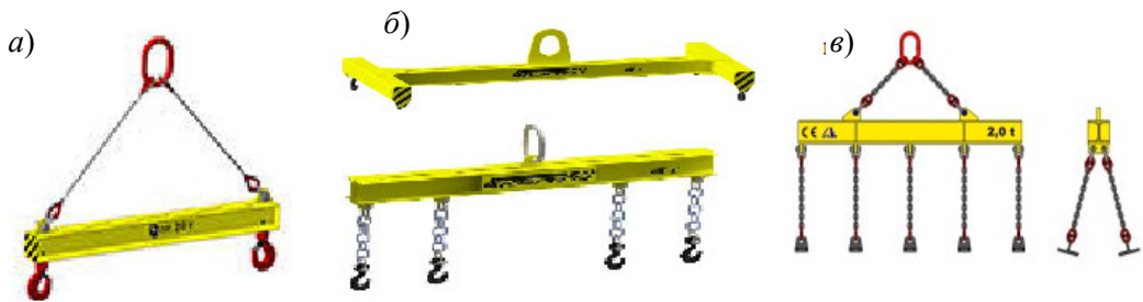
Рис. 5.21. Види траверс: а – двоточкова для монтажу балок, вузьких плит ( https://kzk.kiev.ua/krany-mostovyye-metallurgicheskoye/ ); б – чотирьохточкова, для монтажу плит перекриття, покриття ( https://kzpto.com.ua/uk/traversi/ ); в – багатоточкова, для монтажу довгих вузьких елементів ( https://luczeko.pl/promocje/ )
