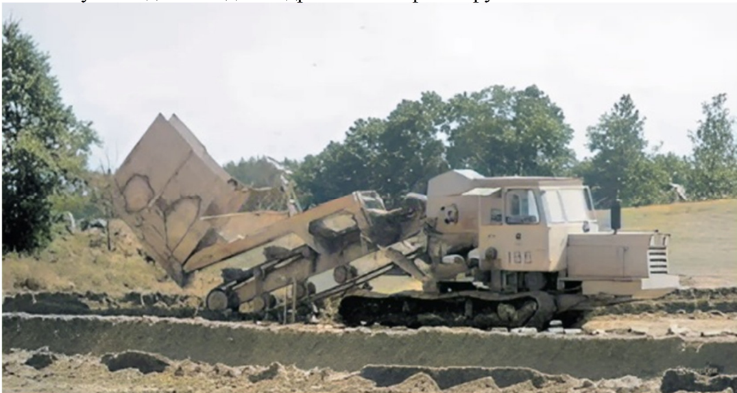
Рис. 1.39. Екскаватор-дреноукладач ЕТЦ-202 (екскаватор траншейний ланцюговий, 2,0 м глибина) для вкладання дренажу, [1], оброблено автором
