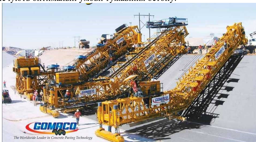
Рис. 3.27, А. Напівпрофільний бетоноукладальний комплекс для облицювання магістральних каналів Gomaco, www.gomaco.com/
