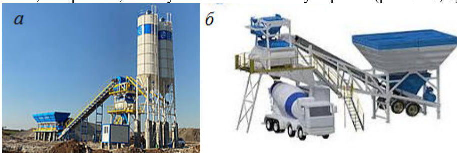
Рис. 5.28. Приоб'єктні бетонозмішувальні установки ( https://machineryline.ua/-/betonni-zavodi--c113 ; https://machineryline.info/-/concrete-plants/Karmel--c113tm10774 )
