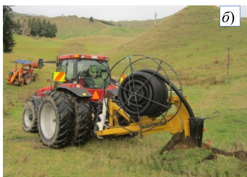
Рис. 1.52. Агрегатування дренажних плугів Soilmax, [31]
