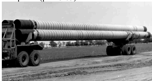
Рис. 3.83. Сталеві труби з бітумно-полімерною ізоляцією і зовнішнім захисним шаром, [1]
