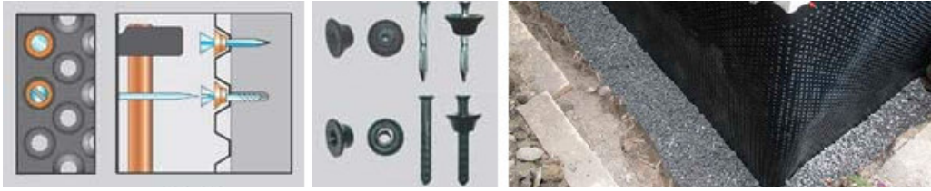
Рис. 7.38. Приклад кріплення текстурованої геомембрани до стіни фундаменту ( https://stroydar.com.ua/ua/a166652-instruktsiya-montazhu-izolit.html )
