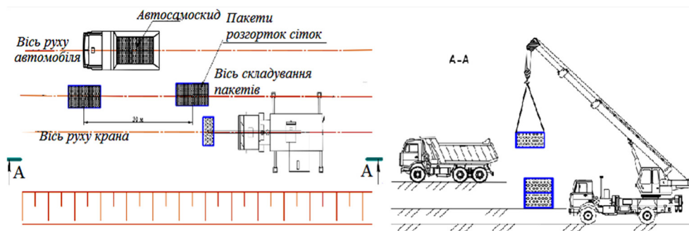
Рис. 6.28. Схема розвантаження пакетів габіонів ( https://ep3.nuwm.edu.ua/15100/1/Posibnyk_TBGTWPS.pdf )
