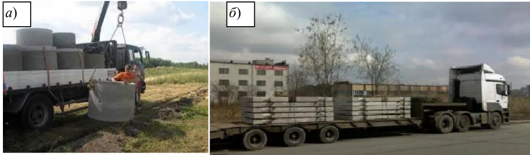
Рис. 5.2. Перевезення залізобетонних виробів автомобільним транспортом: а – кільця колодязів, https://www.mit-net.com.ua/ ; б – плити, https://0442332290.kiev.ua/ua/p54419321-perevozka-shatrovyh-plit.html
