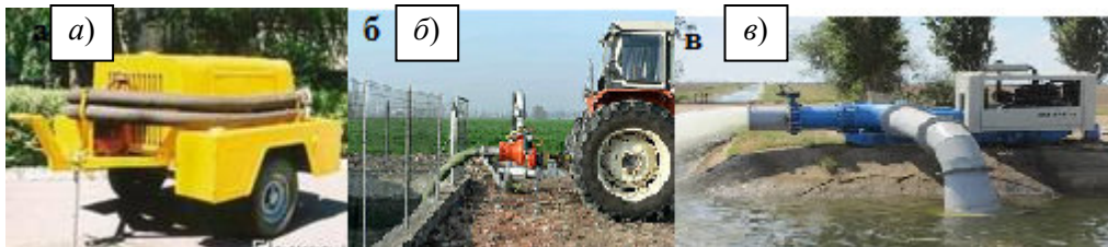
Рис. 5.11. Установки відкритого водовідливу: а – на одноосному шасі ( https://flagma.ua/mm-27-100-tu-22-145-010-90-motopompa-o2762230.html#google_vignette ); б – на тракторі ( https://bioresurs.in.ua/ru/stati/2018/06/nasos-ot-vom-dlya-jidkih-othodov_ss.html ); в – пересувні ( https://prom.ua/ua/p1052758672-stantsiya-nasosnaya-peredvizhnaya.html )
