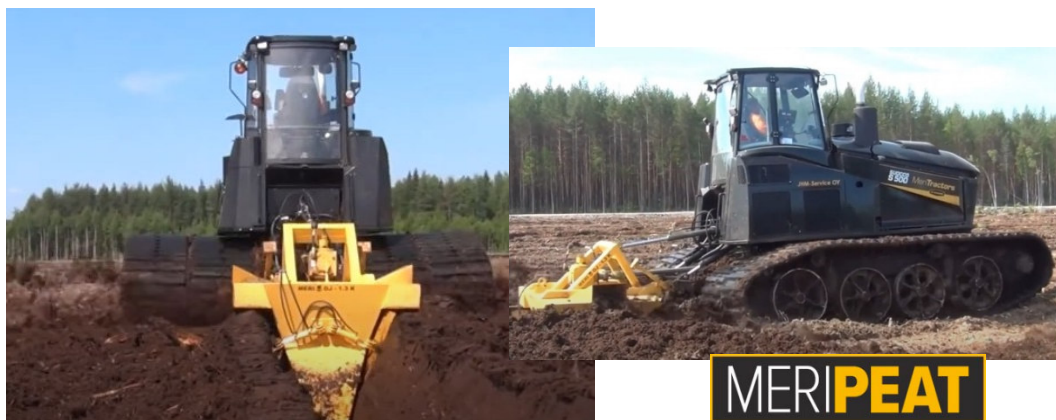
Рис. 1.18. Формування осушувальних каналів MeriPeat ditcher ОЖК-1.3 на базі гусеничного трактора МТ-700 з double rubber tracks, [17]. Джерело фото: youtu.be/V1qATCKSkHg
