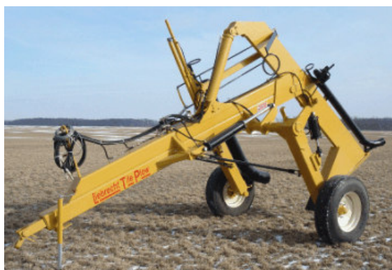
Рис. 1.53. Дренажний плуг Liebrecht: а – плуг в транспортному положенні; б – комплект Trimble для даного плуга
