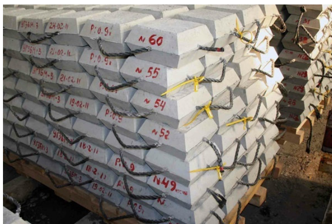
Рис. 6.15. Універсальні гнучкі захисні бетонні мати на піддонах
