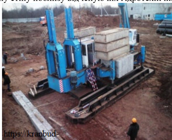
Рис. 6.9. Палевдавлююча мобільна установка (ПВУ) – модель ZYC80 ( https://kranbud-kzk.kiev.ua/palovdavlyuyucha_mobilna_ustanovka )
