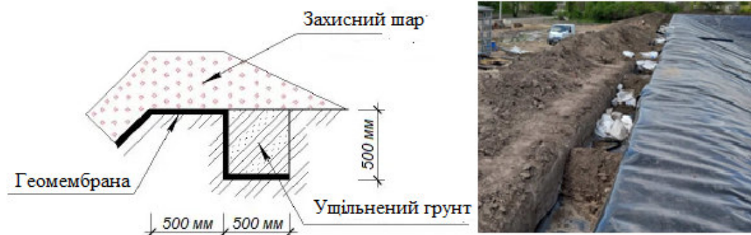
Рис. 7.43. Анкерна траншея для закріплення геомембрани ( https://hydrozahist.com.ua/ru/uslugi/montazh-geomembran/ ; https://excavator.org.ua/ua/gidrotehniche-raboty/stroitelstvo-lagun.html )
