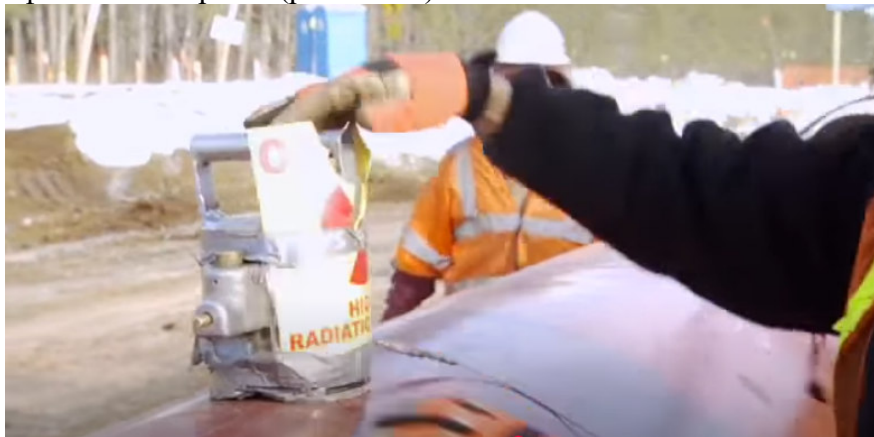
Рис. 3.120. Пристрій для перевірки якості зварного шва, https://youtu.be/Cx2fJFcGgGU .
