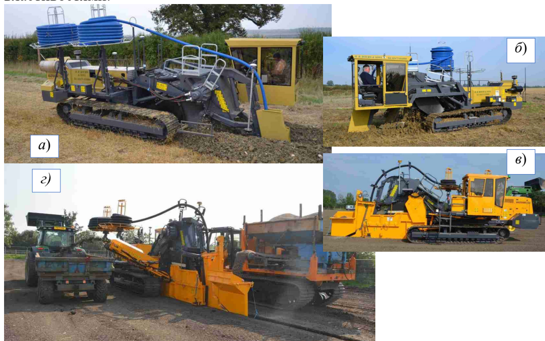
Рис. 1.43. Вузькотраншейний дренаукладач з активним РО Mastenbroek 15/15: а – вкладання дренажу кабіни в робочому положенні; б – те ж вигляд з боку кабіни; в – кабіна в транспортному положенні; г – завантаження вийнятого ґрунту транспортером дренаукладача в транспортні засоби та засипання привозного зворотного фільтру в дренажну траншею через бункер, [24]
