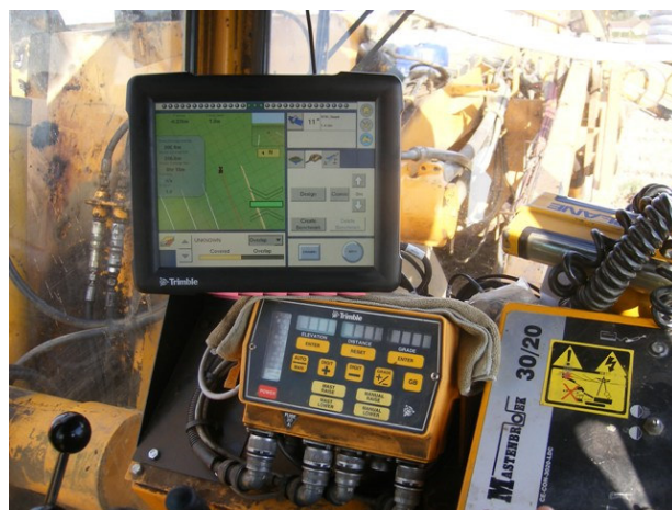
Рис. 1.59. Монітор GPS в кабіні оператора дреноукладача, [27]
