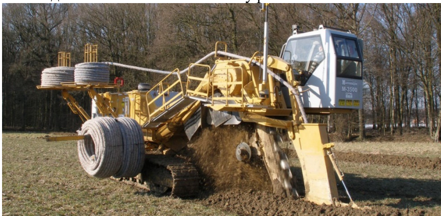
Рис. 4.13. Розміщення бухти з трубами на екскаваторі-дренукладачі Mastenbroek M-3500, [24]
