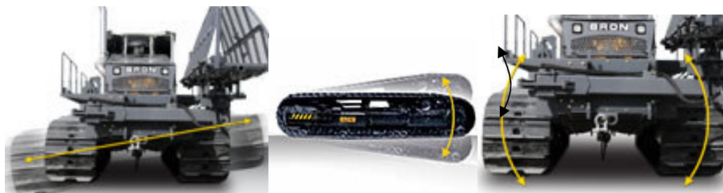
Рис. 1.48. Автоматичне коригування перекосів, [28]
