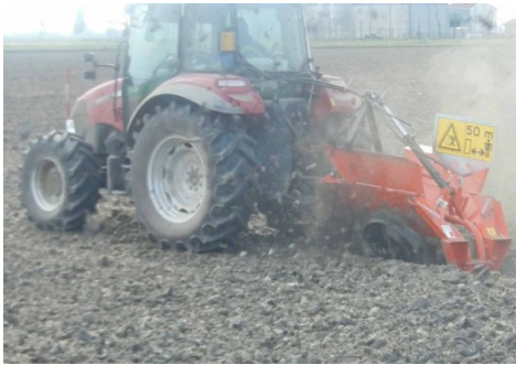
Рис. 1.15. Розробка каналів дрібної мережі ротаційним двохроторним канавокапачем Cosmeso (а) та його робочий орган СВ-120 (б). Фото з сайту https://agro-sintez.com.ua/product/kanalokopatel-dvuhrotornyi/
