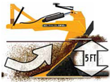
Рис. 1.51. Два варіанти дренажних плугів фірми Soilmax: а – причіпний; б – з 3-х точковою системою начіпки; в – підйом ґрунту по ножу, [31]
