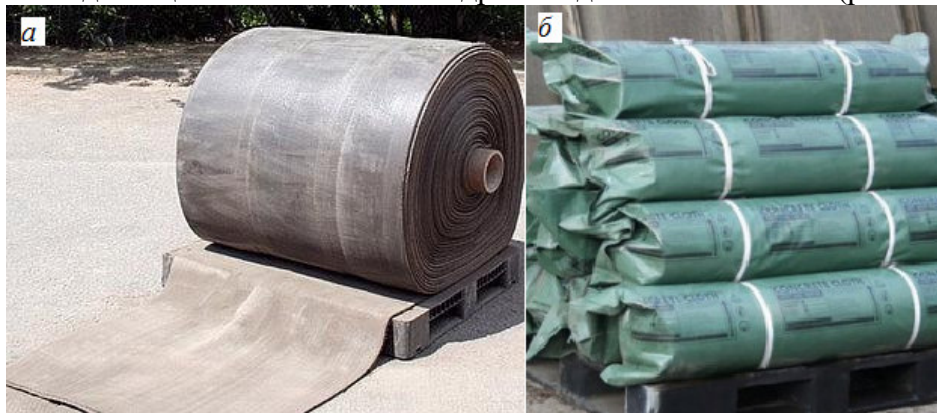
Рис. 6.49. Бетонне полотно: а – у великому рулоні; б – в рулонах малої довжини ( https://in.pinterest.com/jnstewart75/concrete-cloth/ ; http://civilenggseminar.blogspot.com/2017/01/concrete-cloth-page-3.html )
