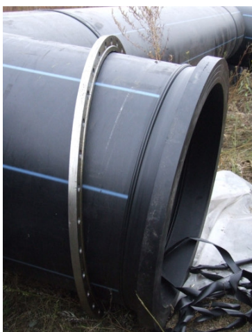
Рис. 3.103. Відбуртований кінець поліетиленової труби з фланцем, [1]
