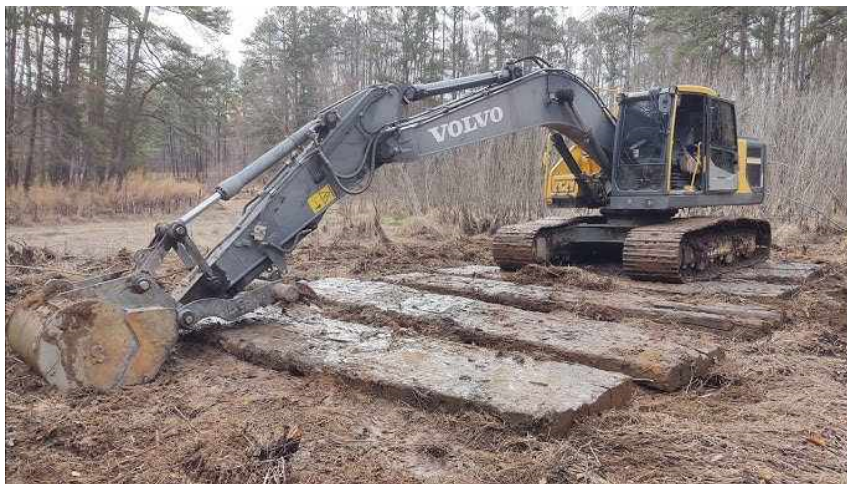
Рис. 1.7. Переміщення екскаватора по дерев'яних настилах, відео доступне за посиланням: youtu.be/LgkoYAHYj6E
