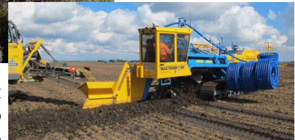
Рис. 1.45. Гусеничний візок для транспортування і навантаження в бункер дренаукладача Mastenbroek 30/20 фільтруючого матеріалу, [24]
