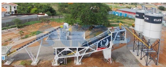
Рис. 3.29, А. Мобільна бетонозмішувальна установка Mobile Master-60 Pegasus-bear-panthera, [52]
