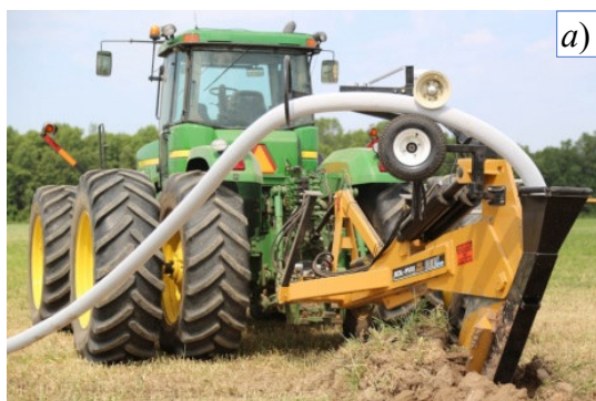
Рис. 1.52. Агрегатування дренажних плугів Soilmax, [31]
