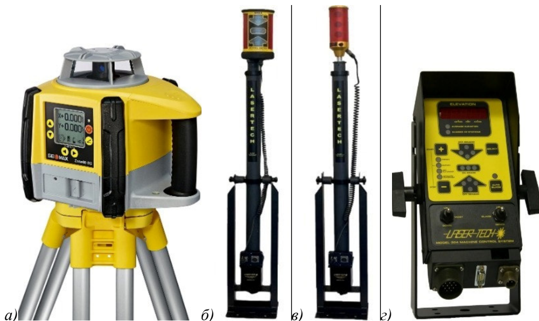
Рис. 1.58. Комплект обладнання для дотримання похилу з використанням лазерного побудовника площини: а – GeoMax Lazer Rotators; б – 419 Mast with 360 Sensor; в – 419 Mast with 367 Sensor; г – LazerTech Model 312 Machine Control System, [39]
