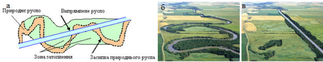
Рис. 7.22. Випрямлення русла річки: а – схема випрямлення; б, в – русло річки до і після випрямлення ( https://elink.io/p/907478e )
