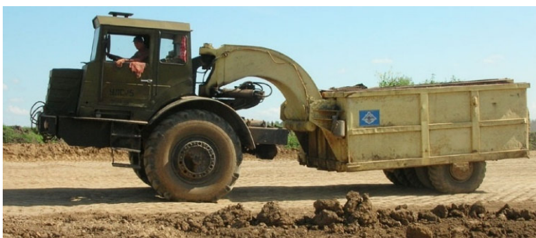
Рис. 3.15. Пневмоколісні котки: а – ДУ-16, [1]; б – SANY SPR160C-8 (16 т), https://hydromarket.com.ua/ua/p1397738503-pnevmocolesnyj-katok-sany.html
