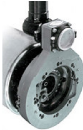
Рис. 3.112. Торцювання крайки сталеві труби
