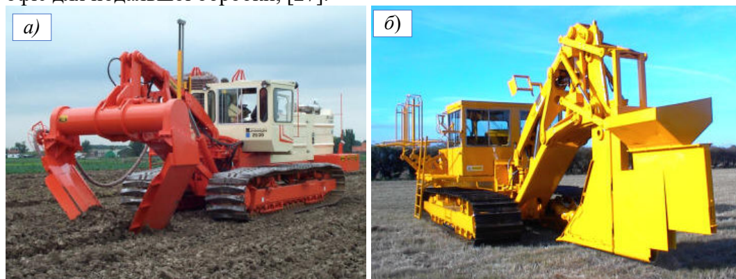
Рис. 1.46. Дреноукладачі фірми Mastenbroek: а – з ножем V-подібної конструкції (V-Plow); б – з одним прямим ножем (Straight Leg Plow), [24]
