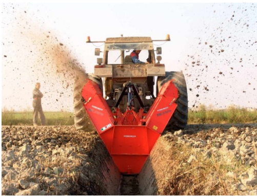
Рис. 1.16. Розробка каналів дрібної мережі ротаційним двохроторним канавокапачем Cosmeso BIG STORM (а) та його робочий орган (б). Фото з сайту https://agro-sintez.com.ua/product/kanalokopatel-dvuhrotornyi-big-storm/
