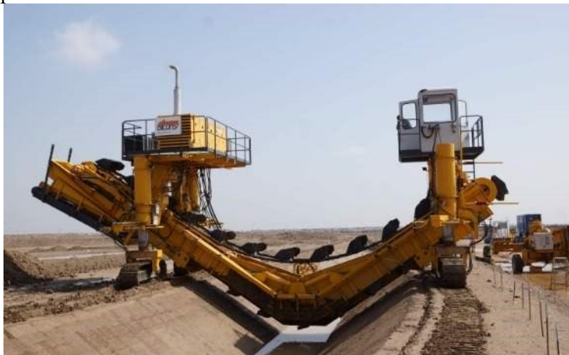
Рис. 3.24. Повнопрофільний екскаватор-планувальник Allcons Maschinbau GmbH, http://en.umax-trade.com/
