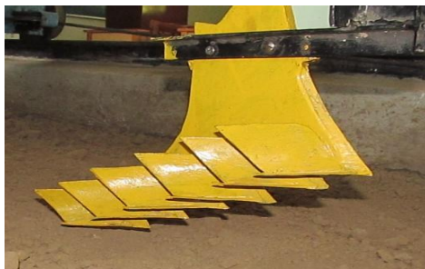
Рисунок 5.1 - Схема фізичної моделі пасивного багатоярусного землерийного робочого органу відвальної конструкції
