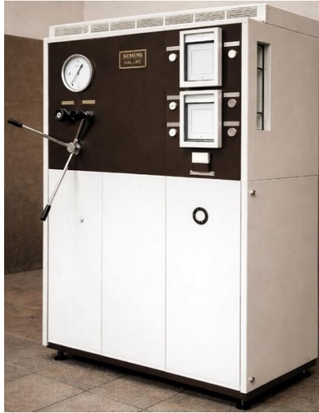
Рис. 3.24. Установка для визначення водовідділення тампонажних розчинів УВЦ-2-м1.
