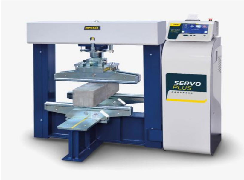
Рисунок 3.31. Розміщення зразка призми при випробуванні міцності на згин.
