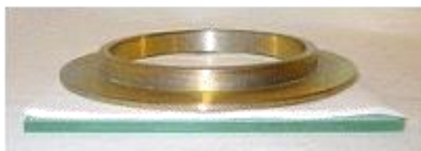
Рис. 3.22. Прилад для визначення водоутримуючої здатності ОВС-6
