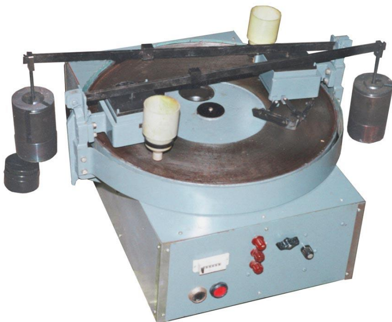
Рис.3.56. Прилад для випробування матеріалів на стирання ИМ–2.
