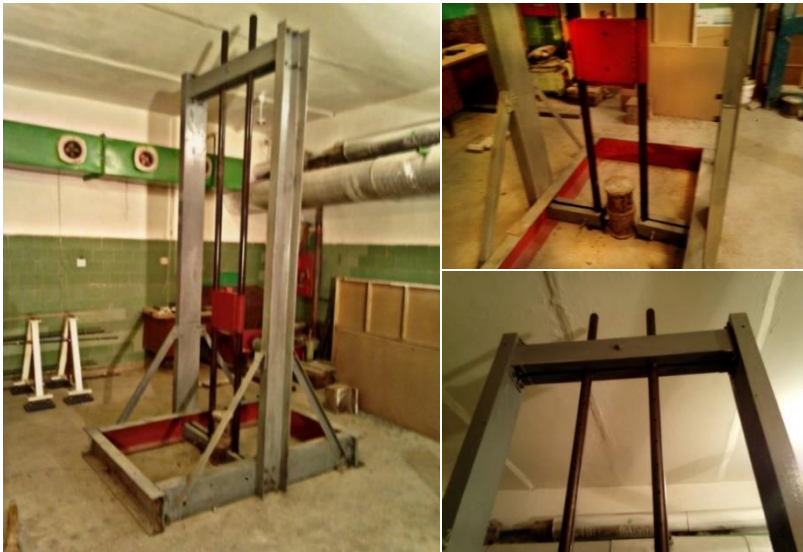
Рис. 3.7 – Загальний вигляд установки для динамічних випробувань бетону.
