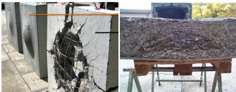
Рис. 8.1. Результат випробувань вибухом залізобетонних плит, підсилених і не підсилених за допомогою РПБ (а) залізобетонна плита із захисним шаром РПБ, для захисту від утворення уламків при руйнуванні (б).
