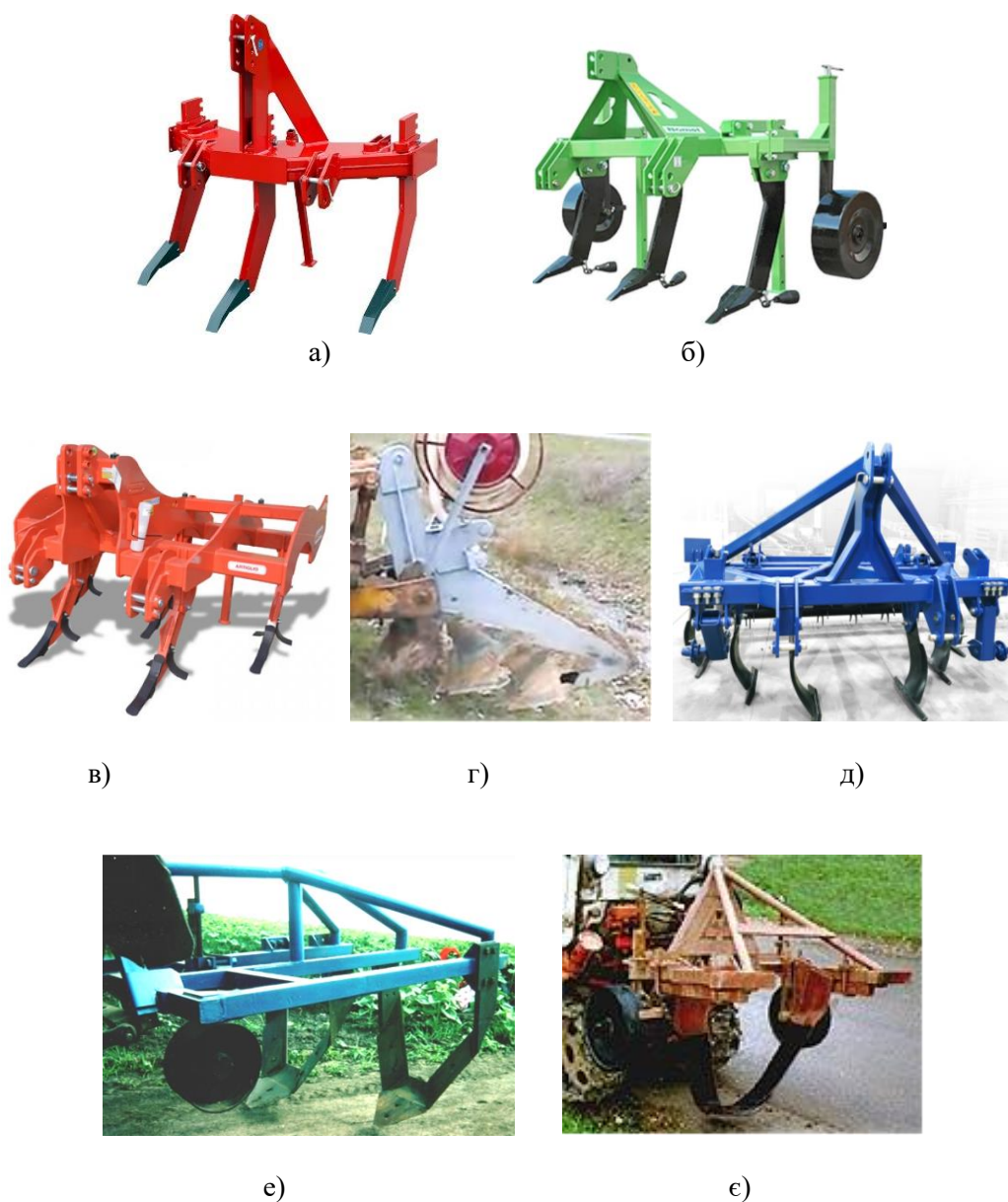
Рис. 1.12. Конструкції пасивних глибокорозпушувачів: стоякові: а) з долотом; б) з дренажами; в) з поширювачами; г) ярусні відвальні; д) з вигнутими стояками; периметрові: е) клинові; є) дугові.
