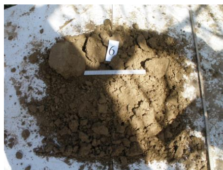
Рис. 4.9. Експериментальні дослідження подрібнення ґрунту: а – надання ґрунту потенціальної енергії; б – стан подрібненого ґрунту
