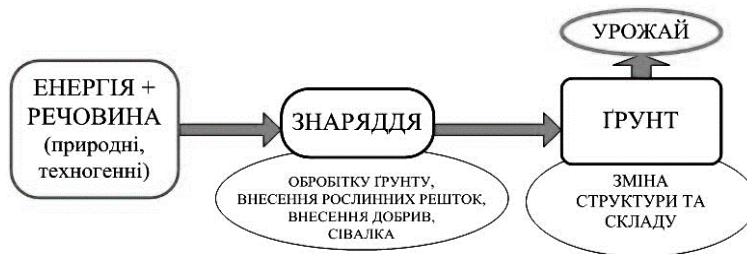
Рис. 2.3. Узагальнена схема технологічного процесу обробки ґрунту для отримання врожаю за В.І. Ветохіним [13]
