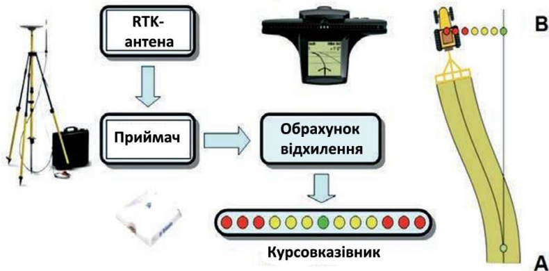
Рис. 4. Принцип функціонування курсовказівника
