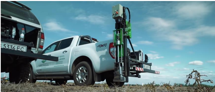
Рис. 23. Мобільний пробовідбірник на автомобільному шасі, SkokAgro, Україна
