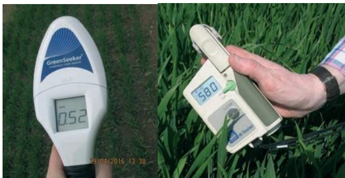
Рис 32. Оптичні датчики для визначення потреби у азотному живленні
