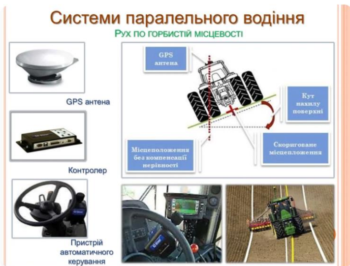
Рис. 5. Типовий склад системи паралельного водіння
