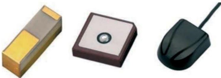
Рис. 2. Малогабаритні антени (чип-антена, патч-антена, зовнішня антена)
