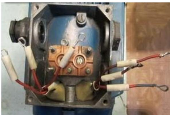
Рисунок 2.2 – Шість виводів обмотки статора асинхронного двигуна
