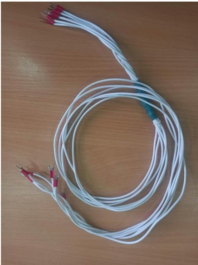
Рисунок 2.8 – Шлейф з немаркованими проводами, що використовується для виконання лабораторної роботи
