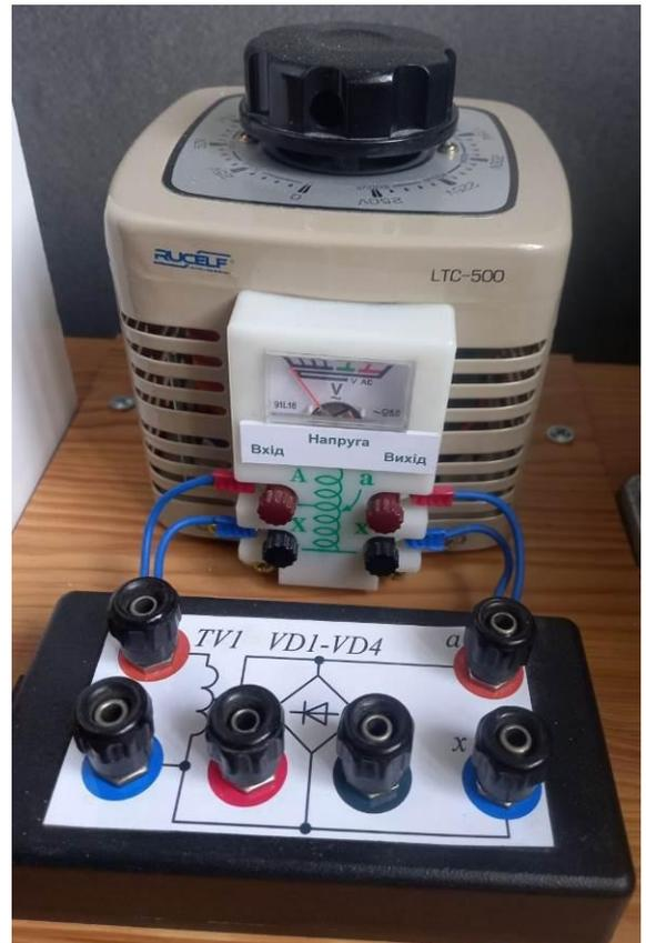
Рисунок 2.9 – Автотрансформатор, що використовується для проведення досліду
