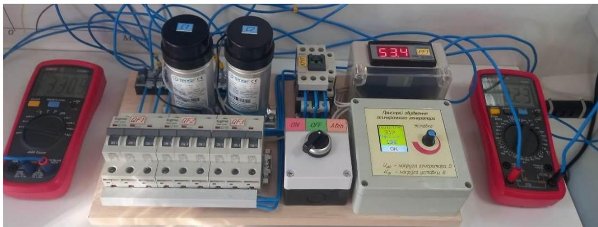
Рисунок 4.4 – Пристрій збудження асинхронного генератора
