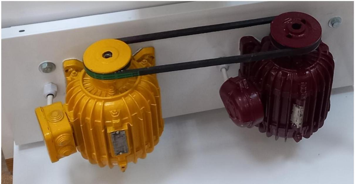
Рисунок 4.2 – Асинхронний двигун та генератор, що використовуватися для проведення дослідів
