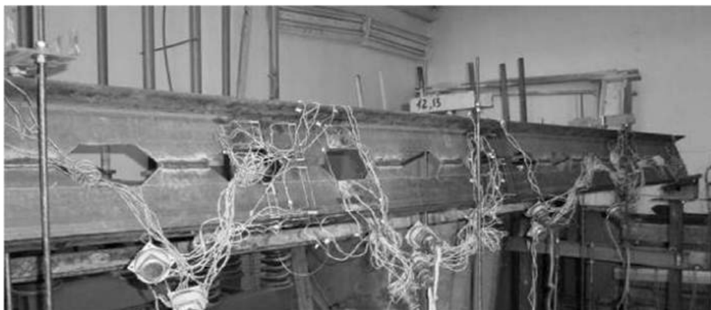
Рис. 3.8. Загальний вигляд дослідної конструкції Z-подібного перфорованого прогону прольотом 6 м та дослідної установки [8]
