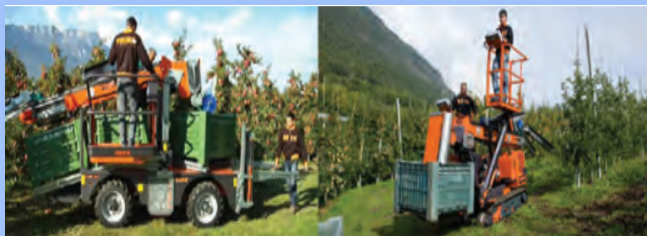
а б Рис. 2.65. Платформи для садів «PIUMA 4WD» (А) і «PIUMA» (Б) фірми «Revo Revolution»
