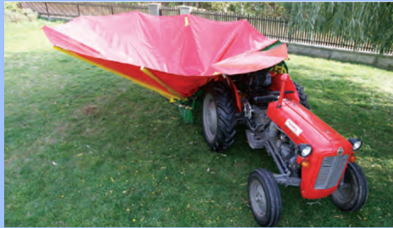
Рис. 2.69. Машина для збирання кісточкових плодових культур виробництва фірми «Elektronik», Сербія
