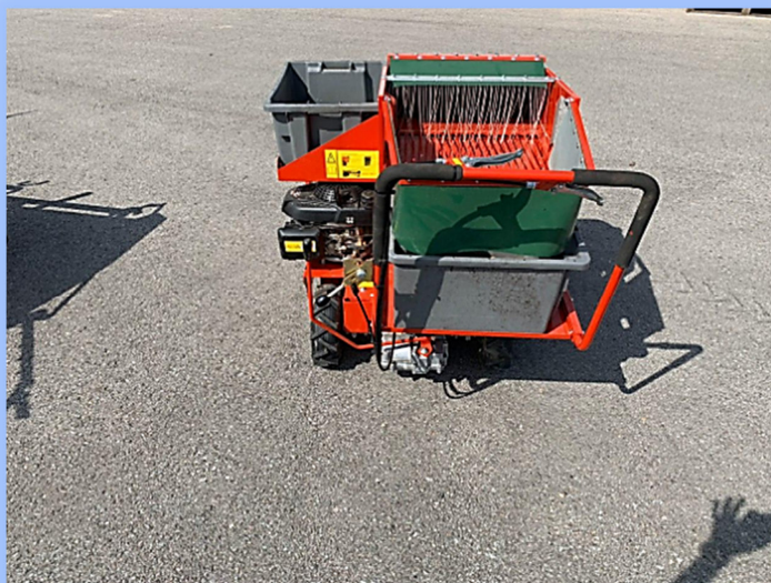
Рис. 2.72. Машина для збирання фруктів ОВ-50
