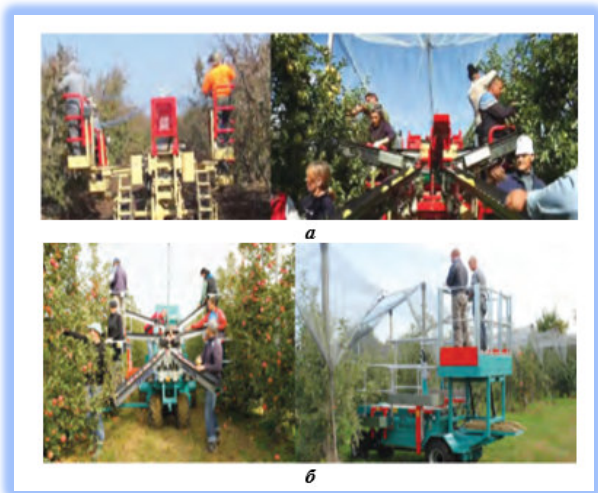
Рис. 2.64. Платформи для збирання плодів і обрізання гілок плодових культур: а – «Tecnofrut» CF 105, б – «Tecnofrut» CF 110 61
