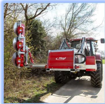
Рис. 2.46. Гідравлічна пила Woodking Wild для обрізки та розчистки посадок 46
