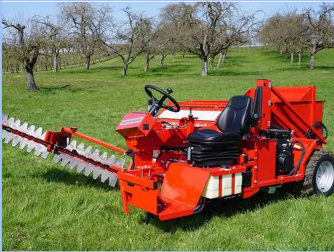
Рис. 2.76. Збиральна машина для фруктів OB 100 A
