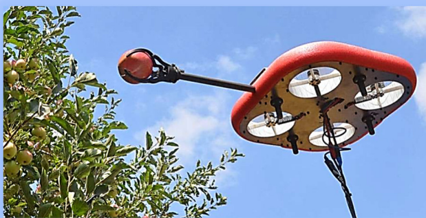
Рис. 2.79 Дрон для збору врожаю яблук фірми Tevel (Ізраїль) https://nauka.ua/news/izrayilskij-startap-navchiv-droniv-zbirati-yabluka
