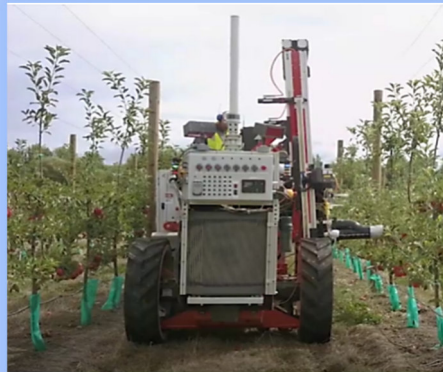
Рис. 2.81. Робот збирач яблук Abundant Robotics 67
