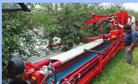
Рис. 2.66. Струшувальний напівпричіпний агрегат «МАJA» фірми «Weremczuk Agromachines», Польща 62
