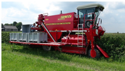
Комбайн для збору шитшини, агрусу, горобини VICTOR PREMIUM
