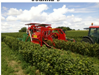
Комбайн для збору ожини, агрусу, аронії VICTOR/Z
