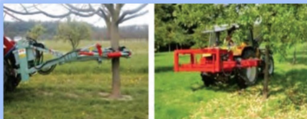
Рис. 2.71. Гідравлічні пристрої для обтрушування плодів фірми «Feucht-Obsttechnik», Німеччина: а) – модель OS; б) – модель VHP; в) – модель VHD; г) – модель VHY; д) – модель VHM
