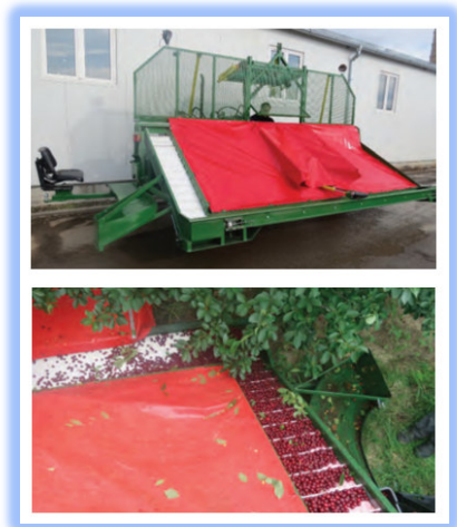
Рис. 2.68. Самохідна машина для збирання плодів SP-8 виробництва фірми «Elektronik», Сербія
