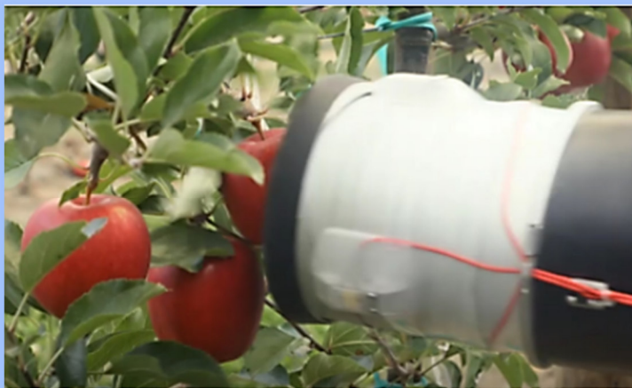
Рис. 2.82. Процес збору яблук роботом Abundant Robotics 68
