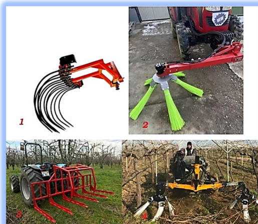
Рис. 2.48. Лозозбірник СВ-1,3: 2 – навісний виноградуковий, вигортач гілок садовий, 3 – пристрій для збирання гілок та лози DT100P гідравлічний, 4 – мітла двостороння Кадіоглу
