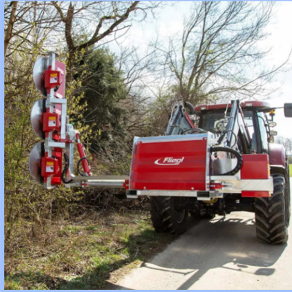
Рис. 1.37. Гідравлічна пила Woodking Wild для обрізки та розчистки посадок 12
