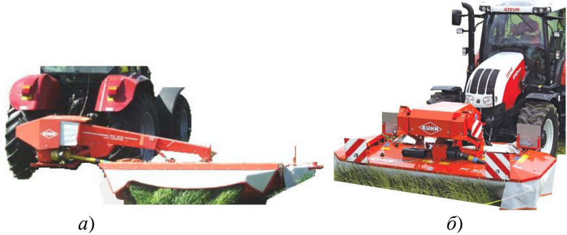
Рис. 1. Навісні косарки-плющилки серії FC фірми «Kuhn» а - задньонавісним FC-283 GII; б - передненавісним FC 313 F
