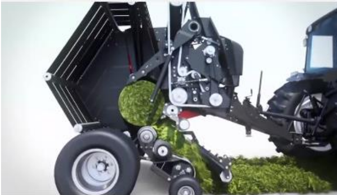
Рис. 11. Робочий процес рулонного прес-підбирача
