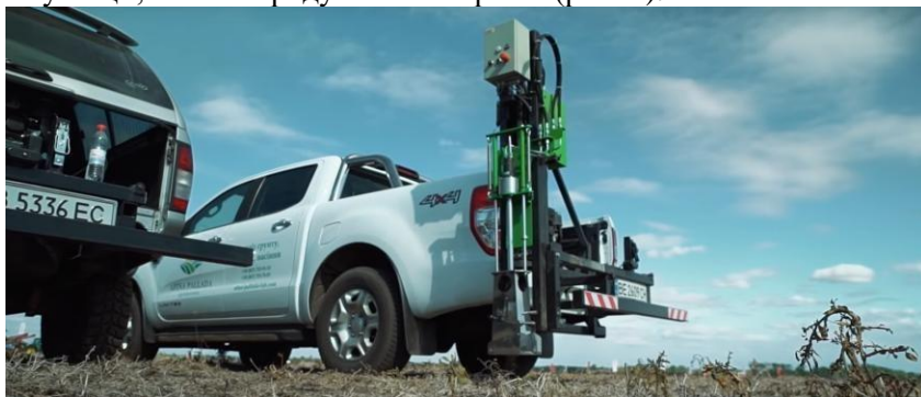
Рис. 1. Мобільний пробовідбірник на автомобільному шасі, SkokAgro, Україна
