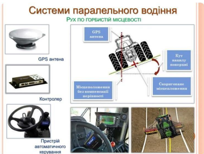
Рис. 2. Типовий склад системи паралельного водіння
