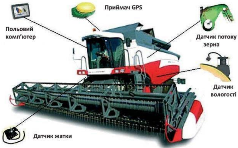
Рис. 1. Розташування обладнання для картування врожайності на зернозбиральному комбайні
