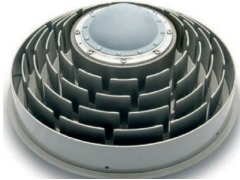
Рис. 3. Choke Ring-антена зі знятим захисним кожухом
