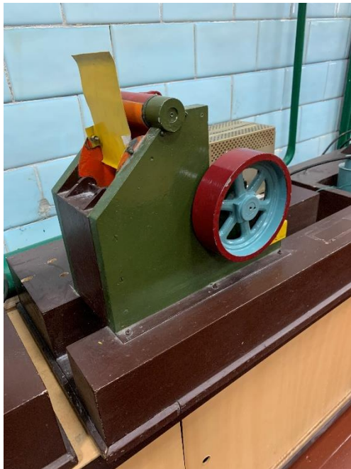
Рис. 1.1. Лабораторна установка щоккової дробарки із простим рухом щоки
