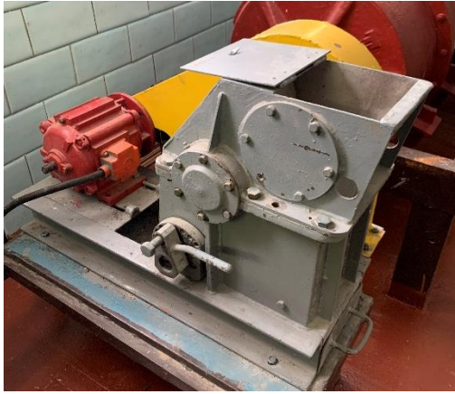
Рис. 1.2. Лабораторна установка щоквої дробарки зі складним рухом щоки
