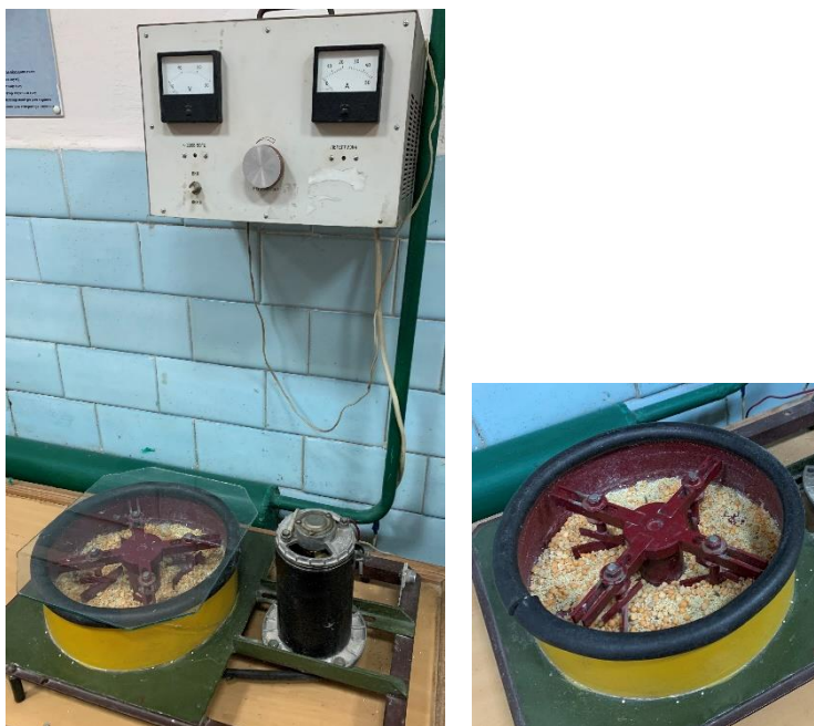
Рис. 5.1. Лабораторна установка роторного змішувача: а – загальний вигляд; б – робоче обладнання
