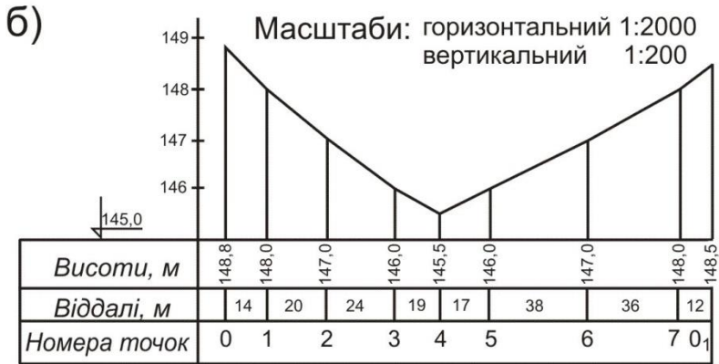
Рис. 2.5. Побудова профілю і лінії з заданим ухилом: а) побудова лінії із заданим ухилом; б) побудова профілю місцевості в заданому напрямку
