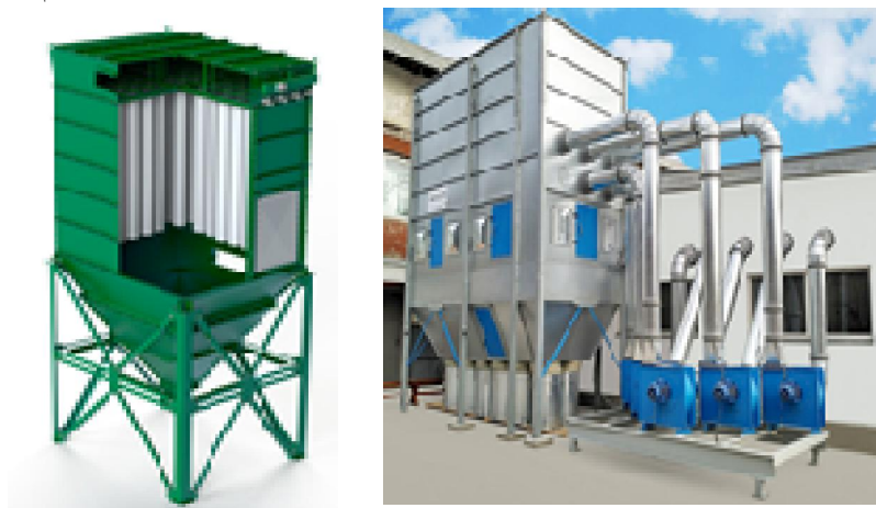
Рис. 5.26. Розріз і загальний вид рукавних фільтрів
