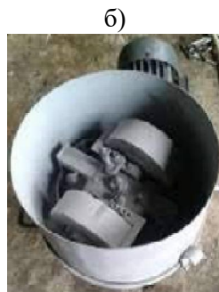
Рис. 2.15. Бігуни: а – загальний вид; б – вид зверху
