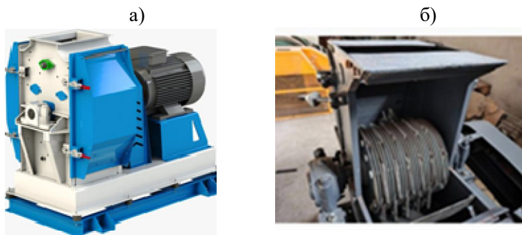
Рис. 2.10. Молоткові дробарки: а – загальний вид; б – розріз
