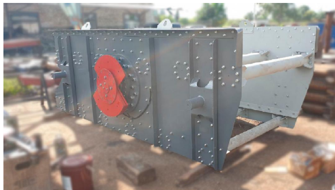
Рис. 4.12. Загальний вид вібраційного грохоту ГІТ-52
