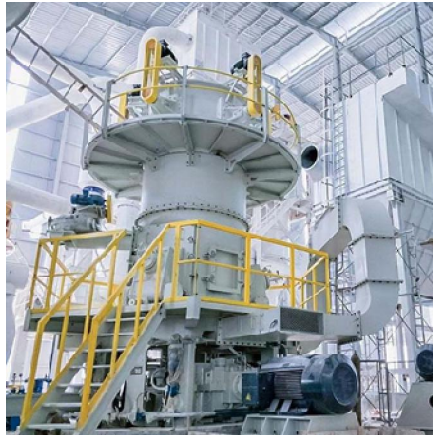
Рис. 3.17. Загальний вид вертикального валкового млина (VRM–Vertical Roller Mill)
