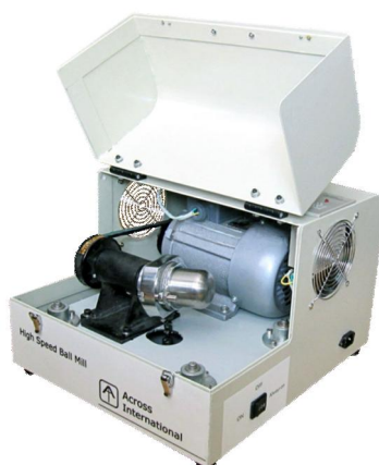
Рис. 2.32. Загальний вид високоенергетичного лабораторного вібраційного млина 80 мл VQ-N
