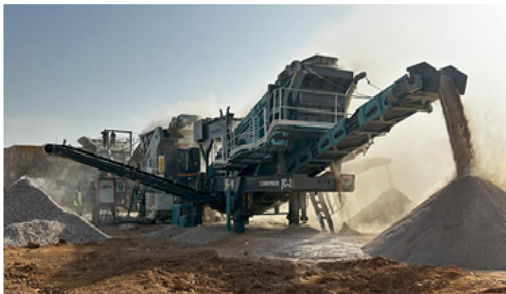
Рис. 3.13. Мобільна модульна установка CONSTMACH JC-1 у робочому стані
