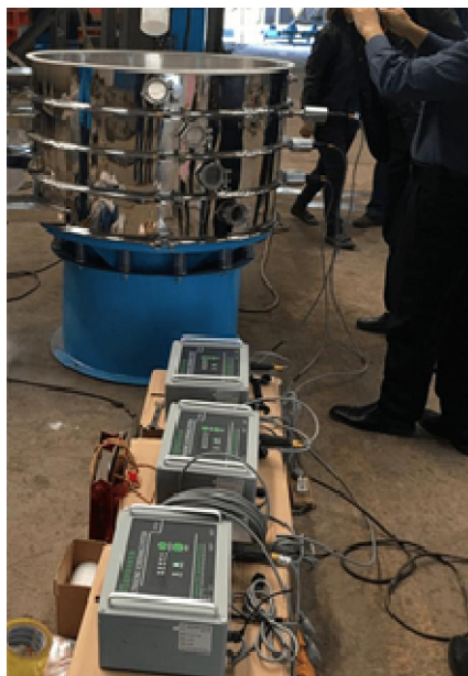
Рис. 4.13. Загальний вид системи ультразвукових сит з генератором GTS30
