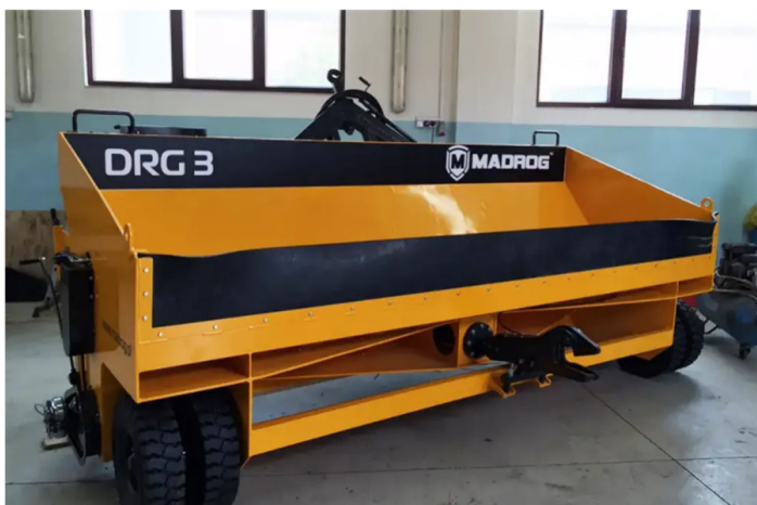
Рис. 2.8. Щебенерозподільник причіпний MADROG DRG 3
