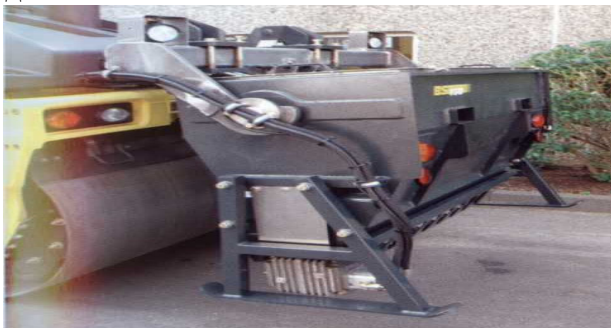
Рис. 5.27. Коток BW 154 з щебенерозмежувачем BS 150
