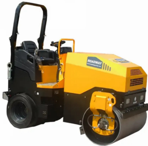
Рис. 2.4. Комбінований віброкоток ROADWAY RWYL82N
