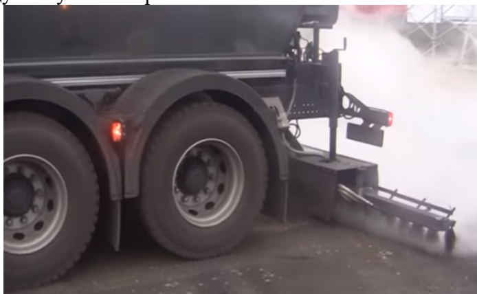
Рис. 3.18. Розливання в'язучої речовини автогудронатором
