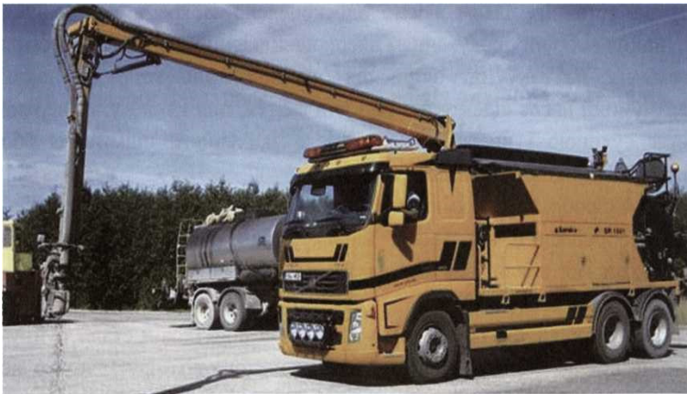
Рис. 3.11. Самохідна машина фірми Savalco (Швеція) для ліквідації ям і вибоїн за струменево-ін'єкційною технологією
