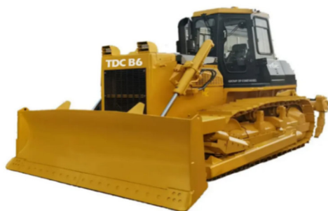
Рис. 2.18. Бульдозер TDC B6
