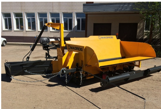
Рис. 2.17. Укладач узбіч з системою нівелювання MADROG
