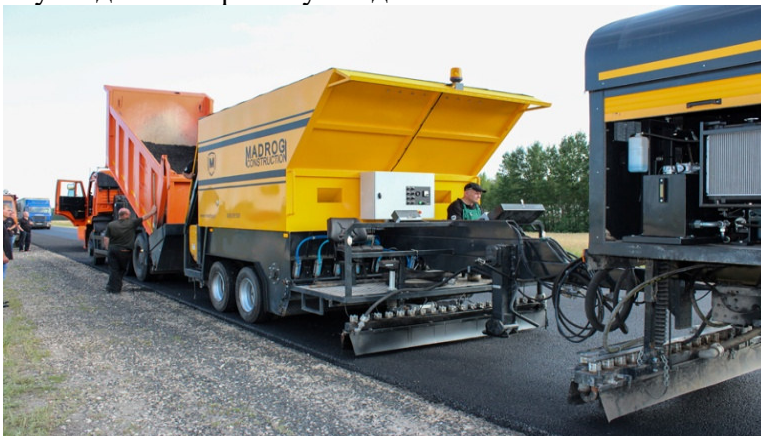
Рис. 2.7. Бітумощебнерозподільник KD 3D
