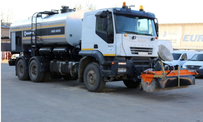
Рис. 2.6. Гудронатор на шасі MADROG SMB 10000
