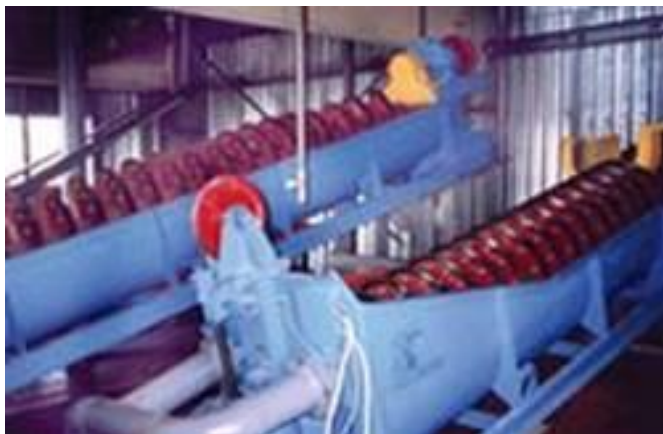
Рис. 2.11. Зневоднення та сушка піску.
