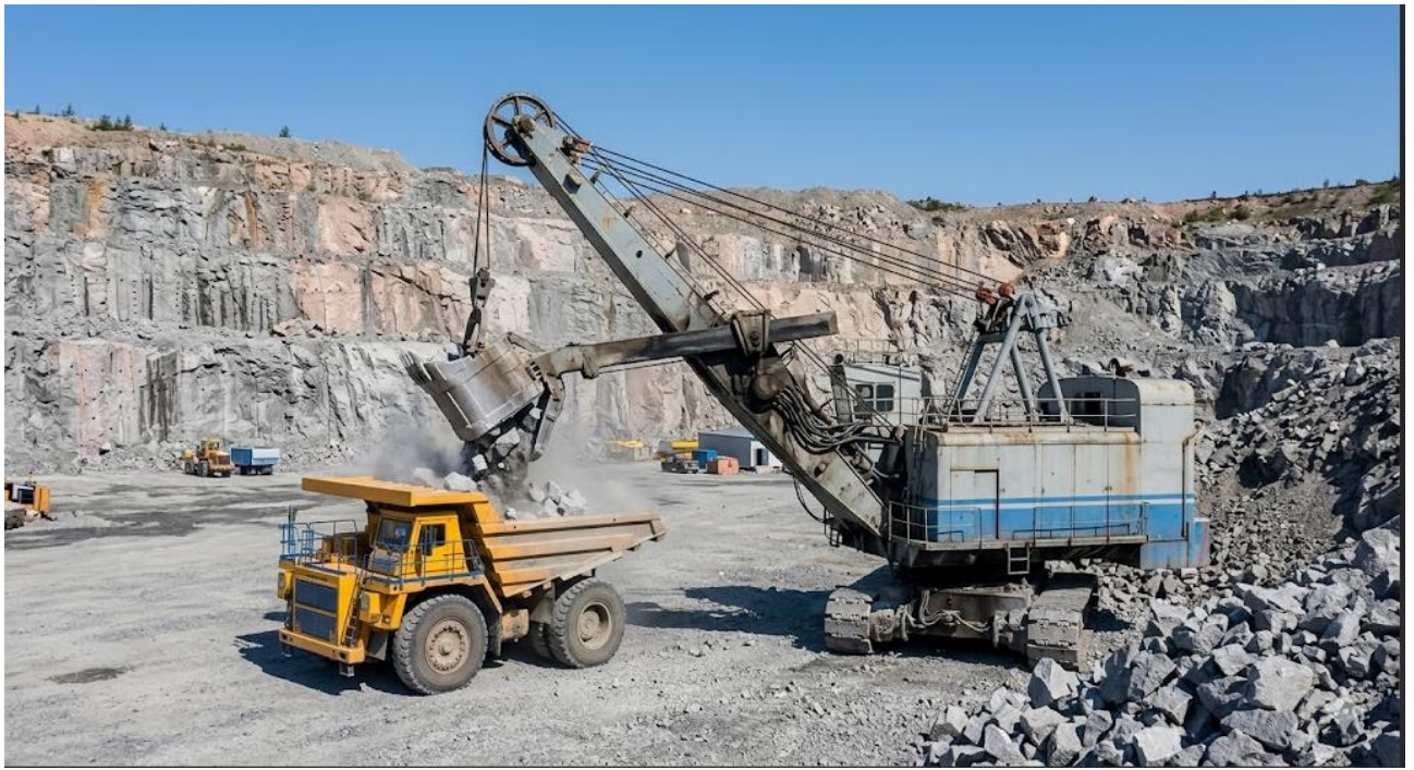
Рисунок 3.3 Вигляд видобувного комплексу ЕКГ-5А та БелАЗ-7547 у вибої
