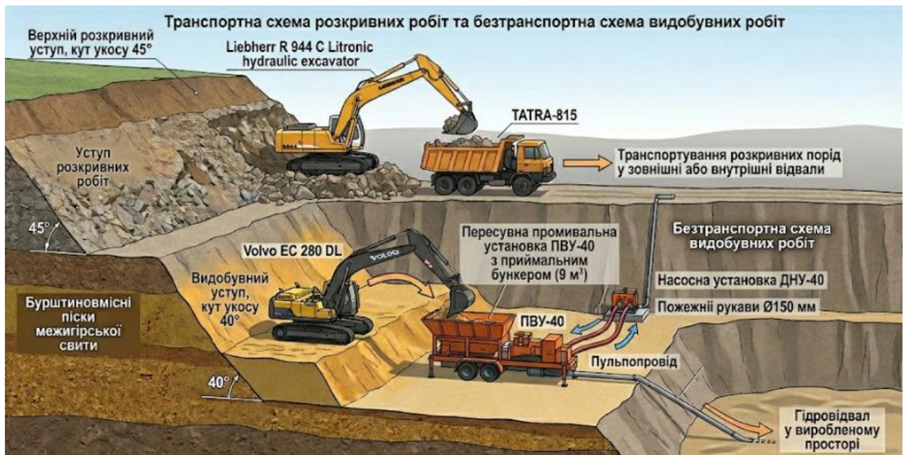
Рисунок 2.1 – Технологічна схема відкритої розробки бурштину комбінованим способом
