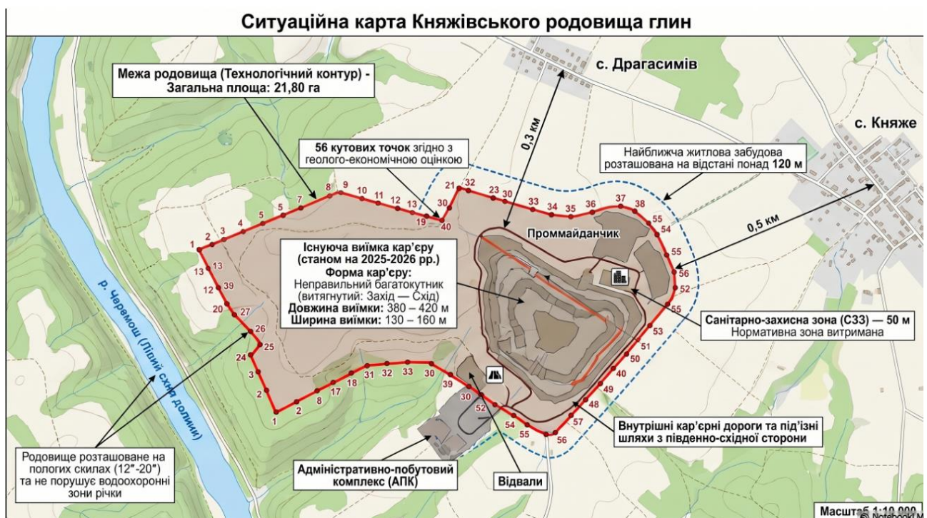
Рисунок 2.4. Схема ведення видобувних робіт у кар'єрі
