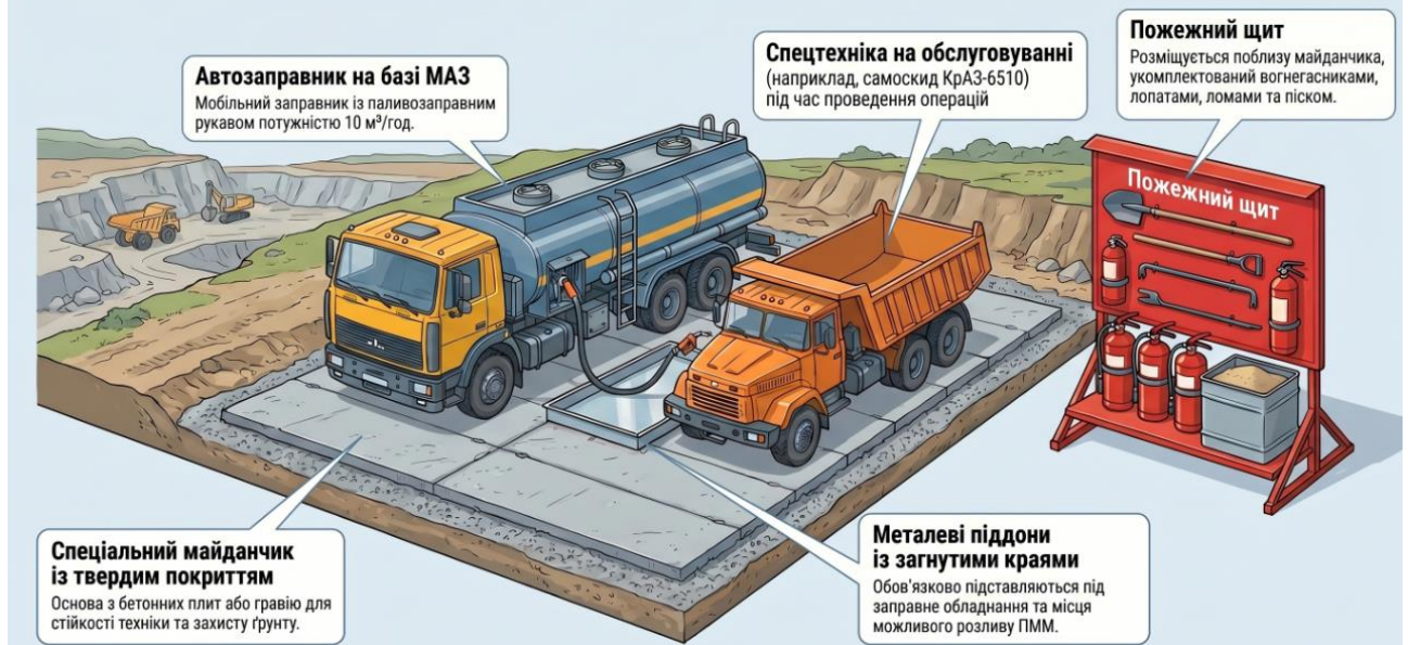
Рисунок 4.1. Організація безпечного місця заправки та обслуговування техніки
