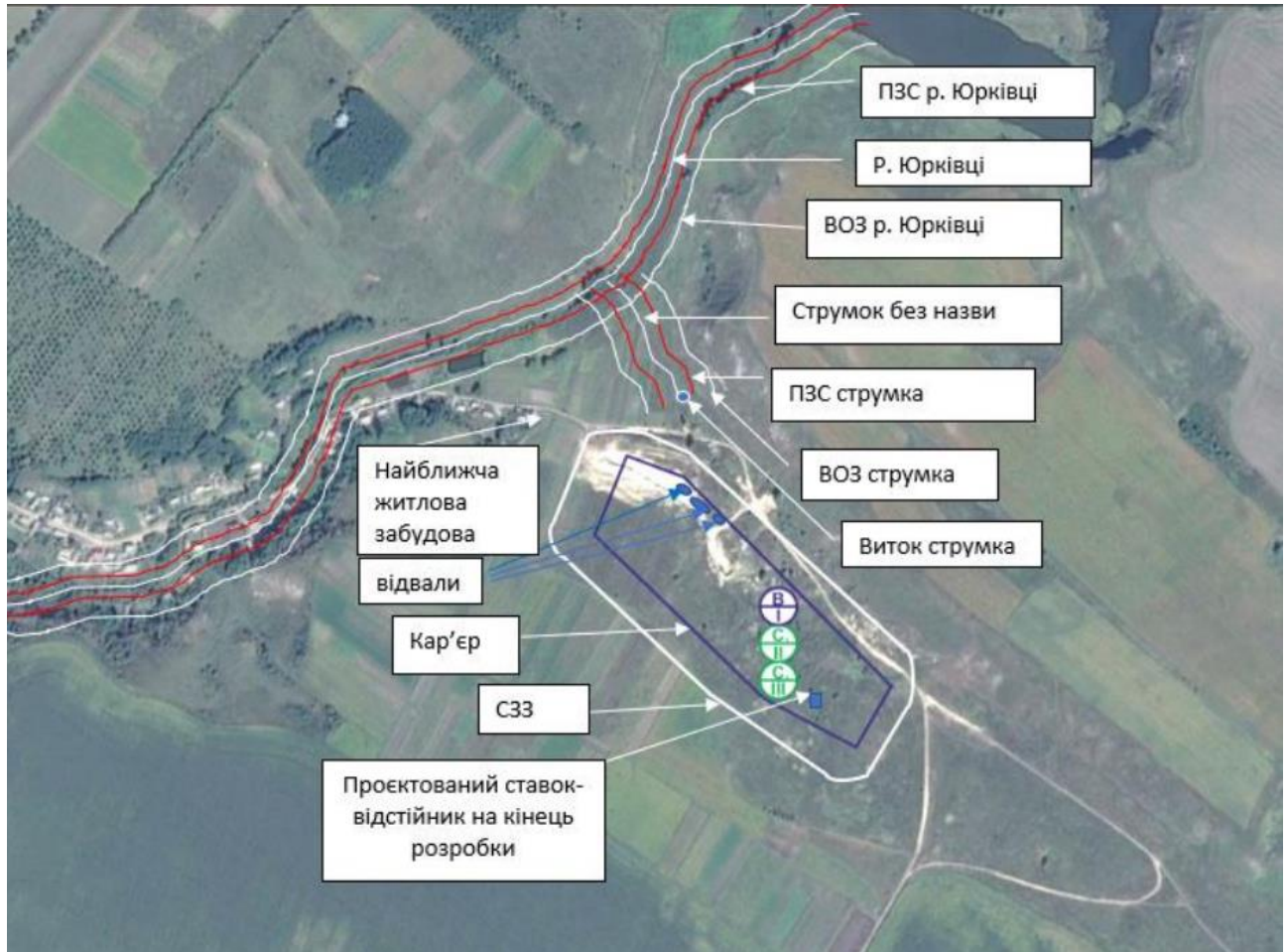
Рисунок 3.3 – Схема розташування ставка-відстійника на кінець розробки родовища
