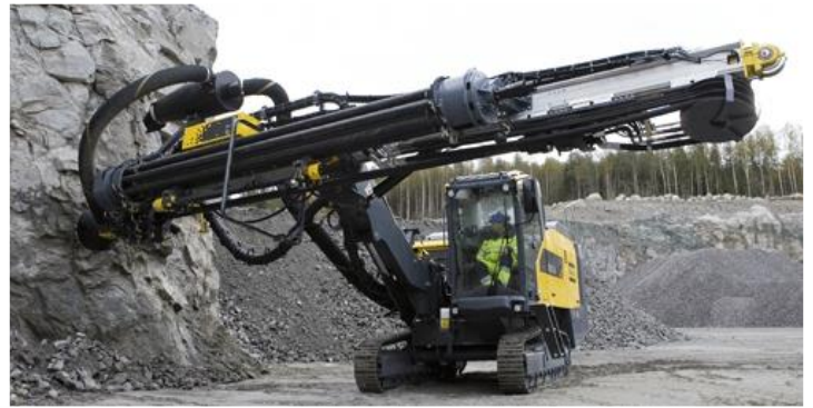
Рис. 1. Буровий верстат «Atlas Copco» для буріння свердловин на кар'єрі: а – вертикальних; б – горизонтальних
