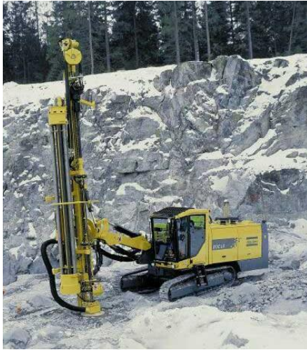
Рис. 1. Буровий верстат «Atlas Copco» для буріння свердловин на кар'єрі: а – вертикальних; б – горизонтальних
