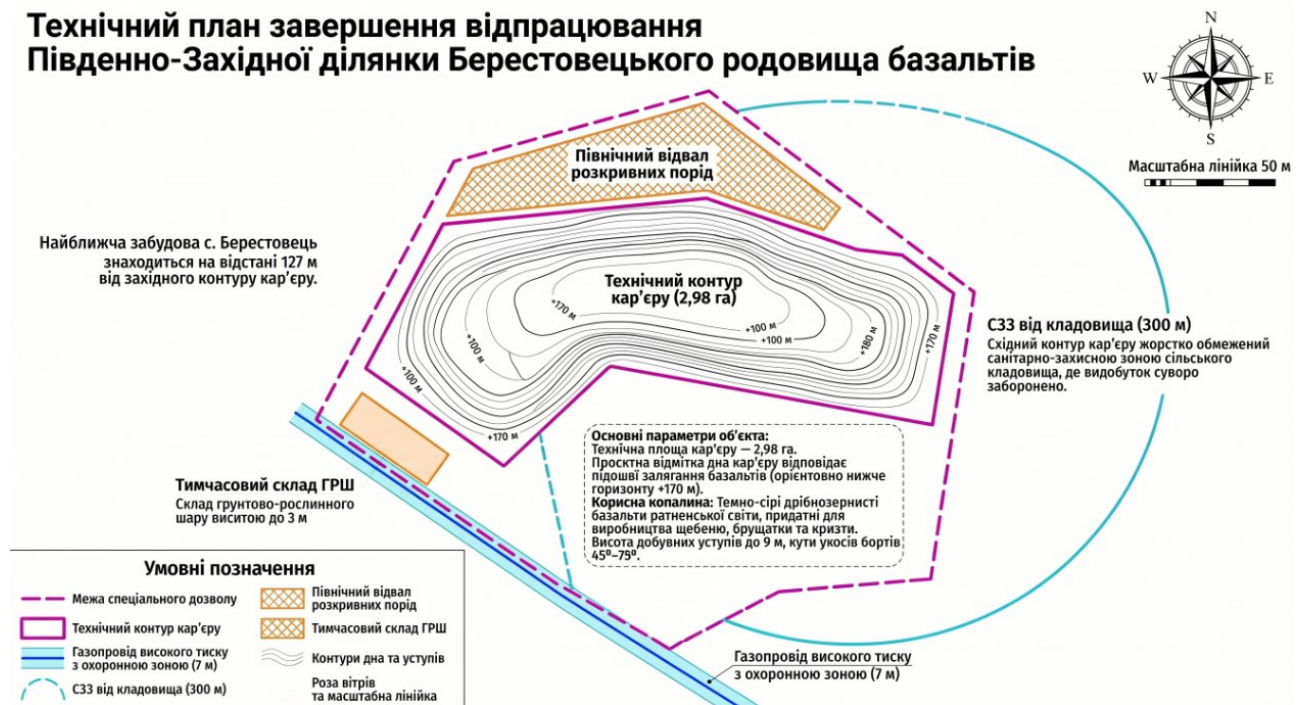
Рисунок 1.2. План на кінець відпрацювання кар'єру Південно-Західної ділянки
