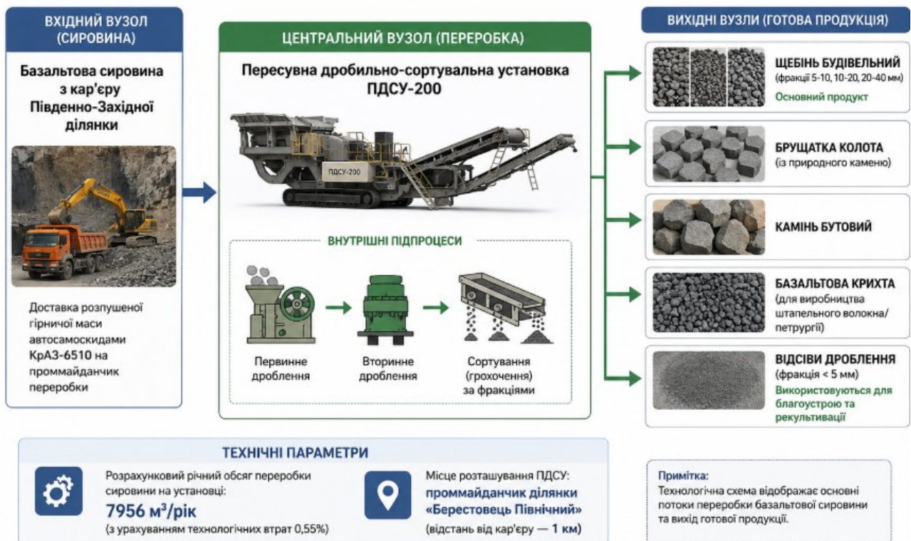
Рисунок 3.1. Технологічна схема переробки базальту на ПДСУ-200
