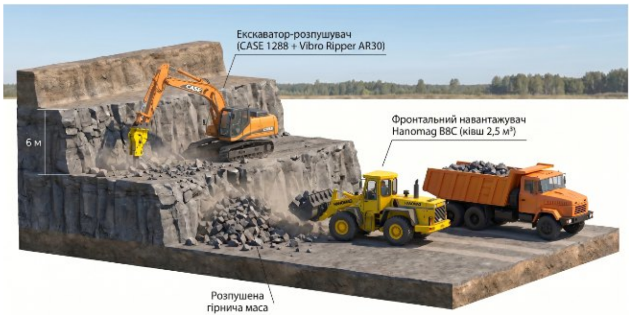
Рисунок 2.3. Технологічна схема роботи екскаватора з вібророзпушувачем у вибої
