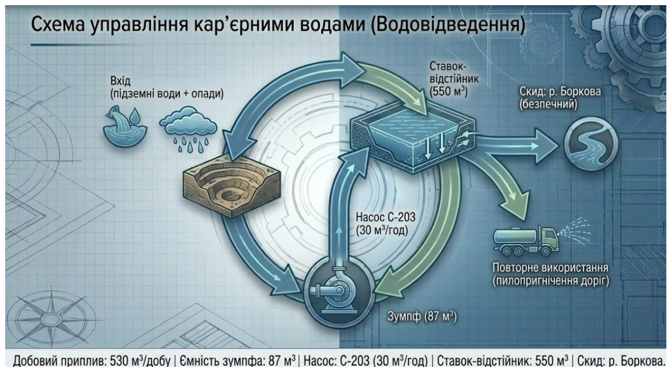
Рисунок 3.2. Схема водовідведення та розташування очисних споруд
