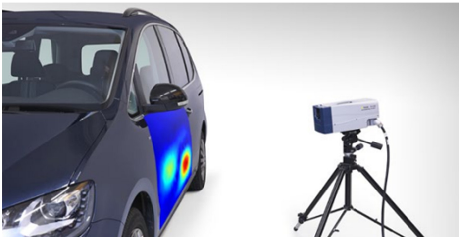
Рис. 1. Повнопольовий вібраційний аналіз за допомогою скануючого віброметра
