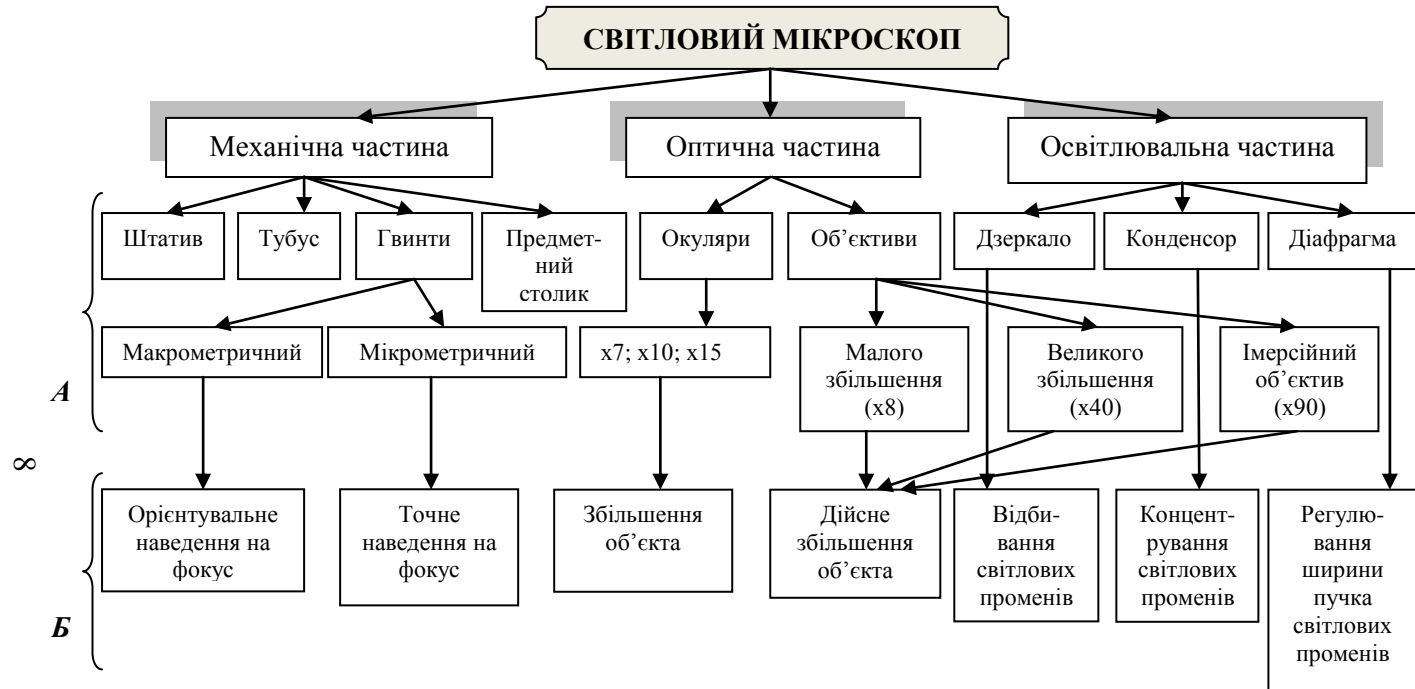
Рис. 1.3 Структурно-логічна схема будови світлового мікроскопа: А – будова; Б – призначення.
