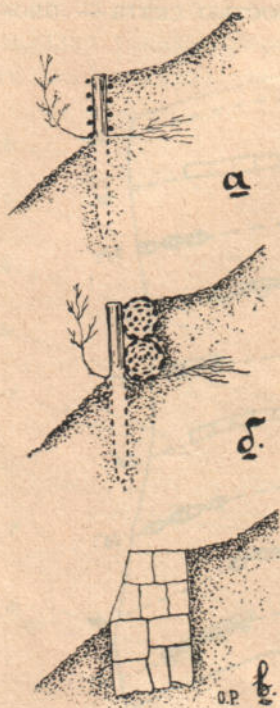
Рис. № 20. Прерывающіяся запрудки—въ поперечномъ разрѣзѣ: a —изъ переплетенныхъ кольевъ, b —изъ фашичника, в —изъ камня.
