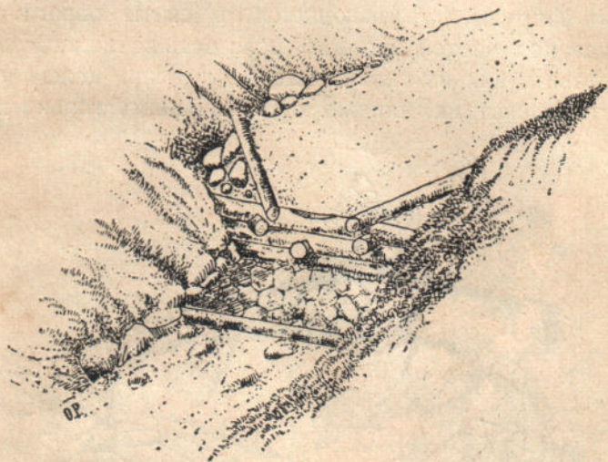
Рис. № 7. Деревянная запруда безъ свай.
