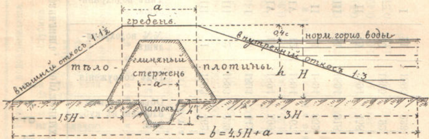
Черт. 6. Поперечный разръзъ плотины, нормальныхъ размѣровъ.
