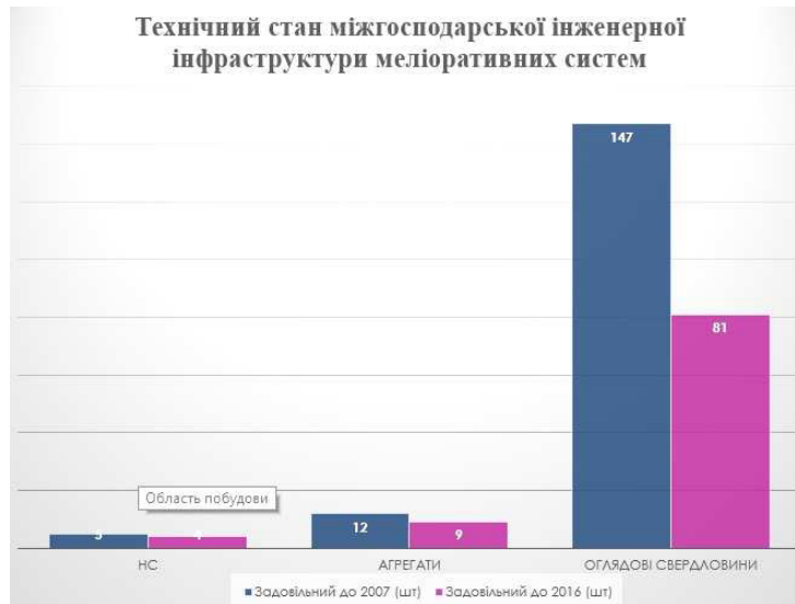
Рис. 2. Гістограми аналізу технічного стану насосних станцій, їхніх агрегатів та оглядових свердловин в динаміці по роках
