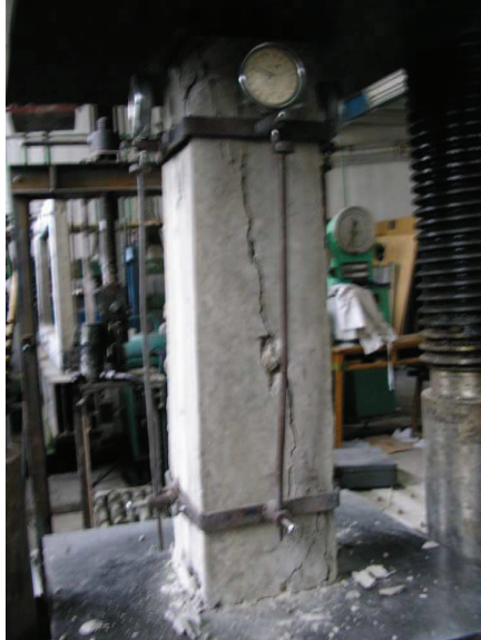
Рис. 2. Характер руйнування призм
