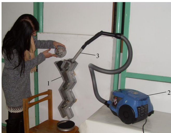
Рис. 3. Дослідна установка для пневмокласифікації: 1 – пневмокласифікатор типу «Зиг-заг»; 2 – пилюсмок; 3 – трубопровід
