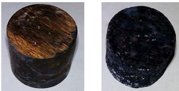
Рисунок. Зразки сталі 20: а – до ХТО, б – після ХТО
