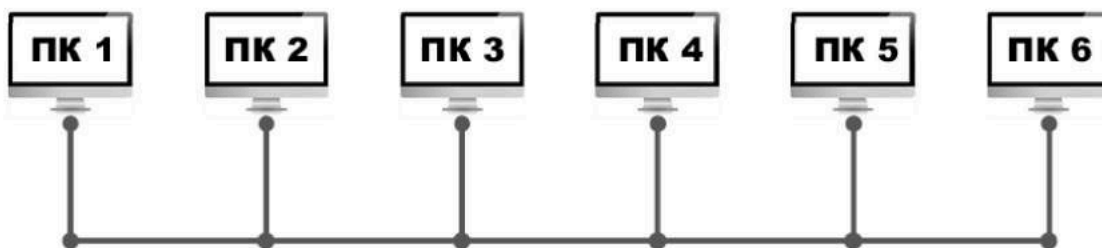
Рис. 6.1. Топологія комп'ютерної мережі Шина
