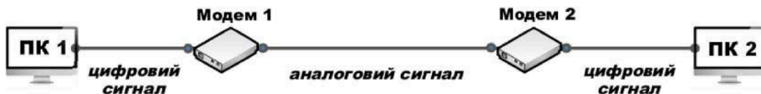
Рис. 6.9. Передавання даних між комп'ютерами через телефонні лінії зв'язку з використанням модемів
