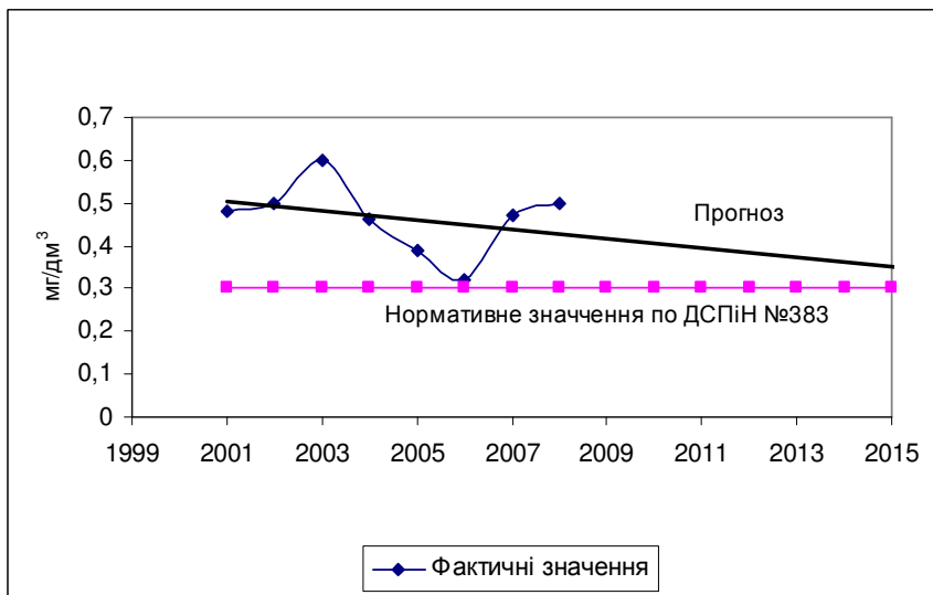
Рисунок. Трендові моделі динаміки вмісту заліза в питній воді централізованих джерел водопостачання за середньорічними показниками з прогнозом до 2015 р.
